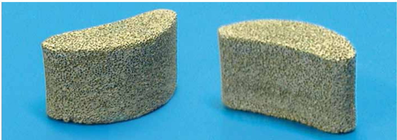
Figura 2. Modelo experimental seleccionado. Caja intersomática para columna lumbar.
