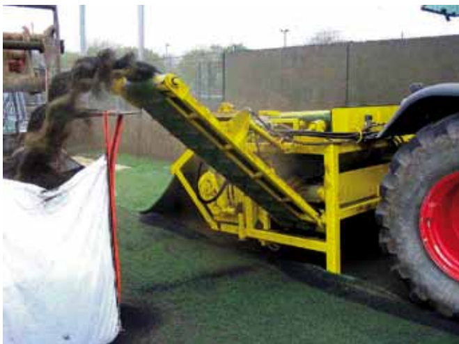
Figura 5. Máquina de separación de los materiales que componen un campo de hierba artificial.
