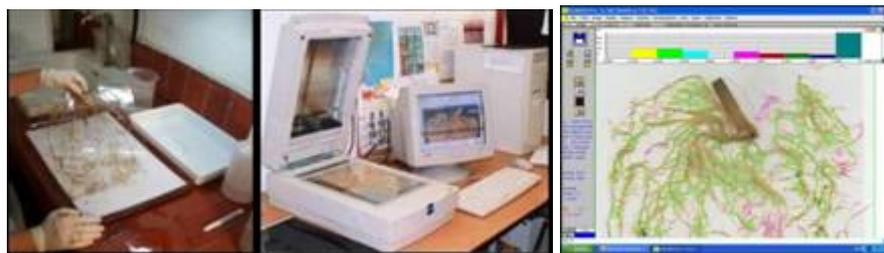
**Figura 1.** Raíz lavada y escaneada. Análisis de la misma con el programa WinRhizo, que facilita la determinación precisa de la estructura de la raíz.
