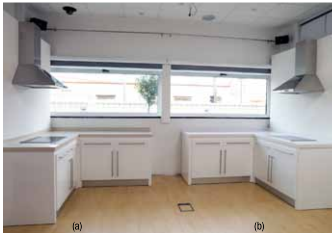
Figura 1. Prototipos montados en el Living Lab del IBV. (a): encimera 1- cerámica; (b): encimera 2- material sintético.
