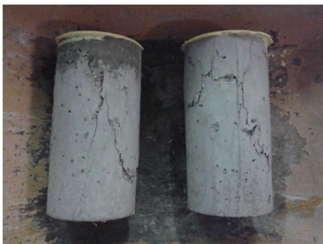
**Figura 5.6.** Rotura a siete días de las probetas de la primera amasada.
