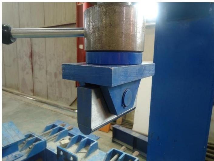
**Figura 9.3.** Rótula de carga fijada al accionador hidráulico.
