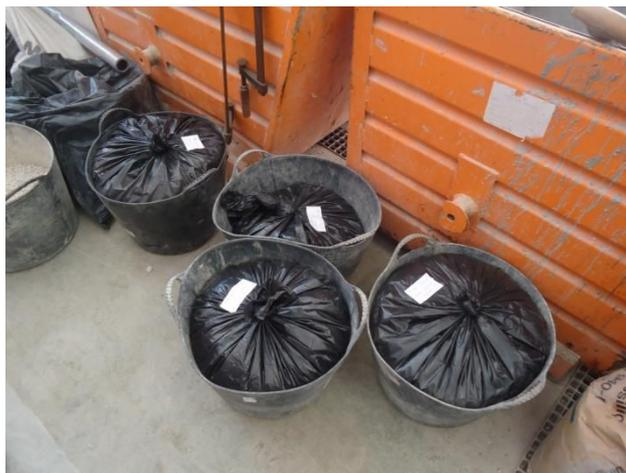
**Figura 5.10.** Separación de los áridos en bolsas para mantener su humedad.
