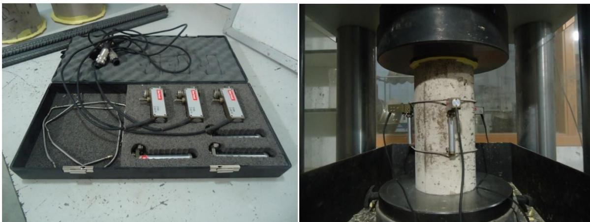
**Figura 5.9.** a) Sistema de tres extensómetros para la determinación del módulo de Young estático a compresión del fabricante Ibertest; b) Instalación del equipo de medida del módulo de Young en la probeta.
