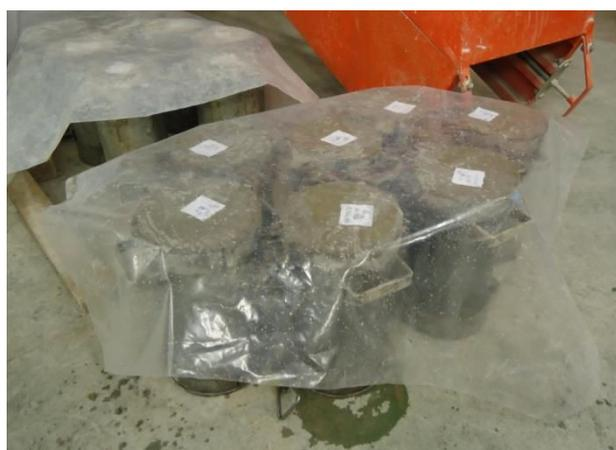
**Figura 5.5.** Conservación de las probetas durante las 24 horas anteriores al desmolde.
