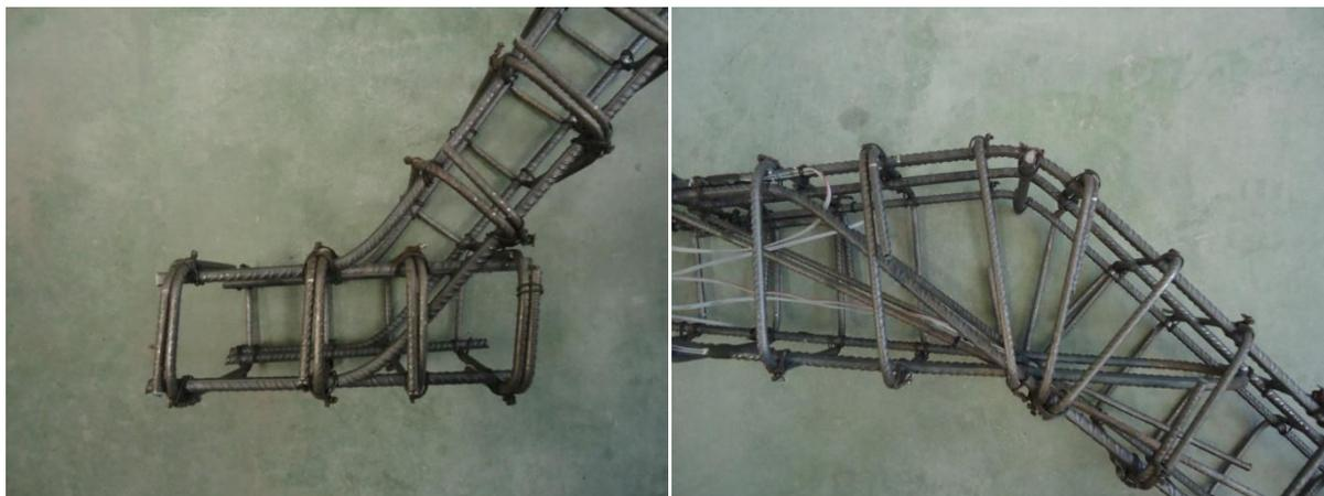
**Figura 8.14.** a) Detalle de la ferralla armada del apoyo derecho; b) Detalle de la ferralla armada de la región de discontinuidad KL.
