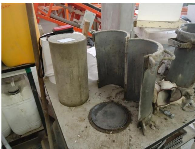
**Figura 5.13.** Una de las probetas de control tras ser desmoldada.
