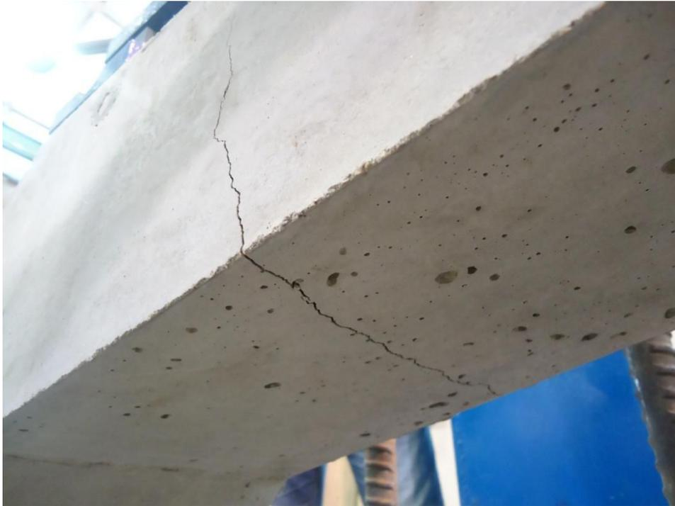
Figura 10.13. Fisura de la sección G tras la descarga.
