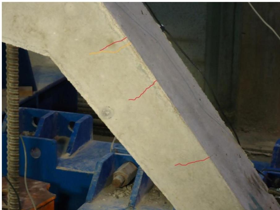
**Figura 10.8.** Representación de fisuras en la pila derecha sobre una imagen tomada a una carga de 126 kN.
