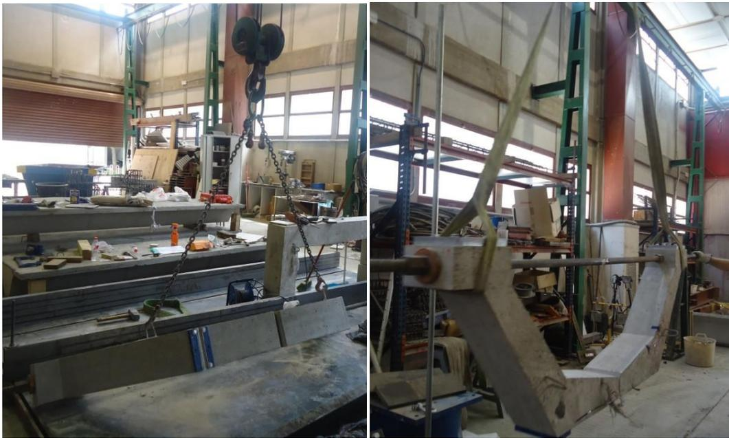
**Figura 9.5.** a) Izado de la estructura; b) Traslado de la estructura hasta el pórtico de ensayo.
