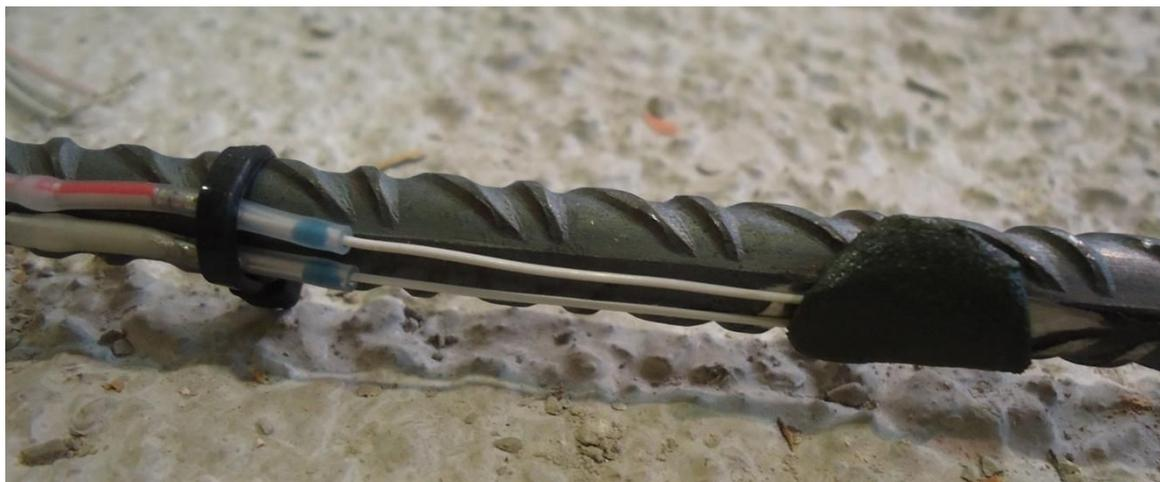
Figura 9.8. Galga de acero colocada sobre una de las armaduras longitudinales.
