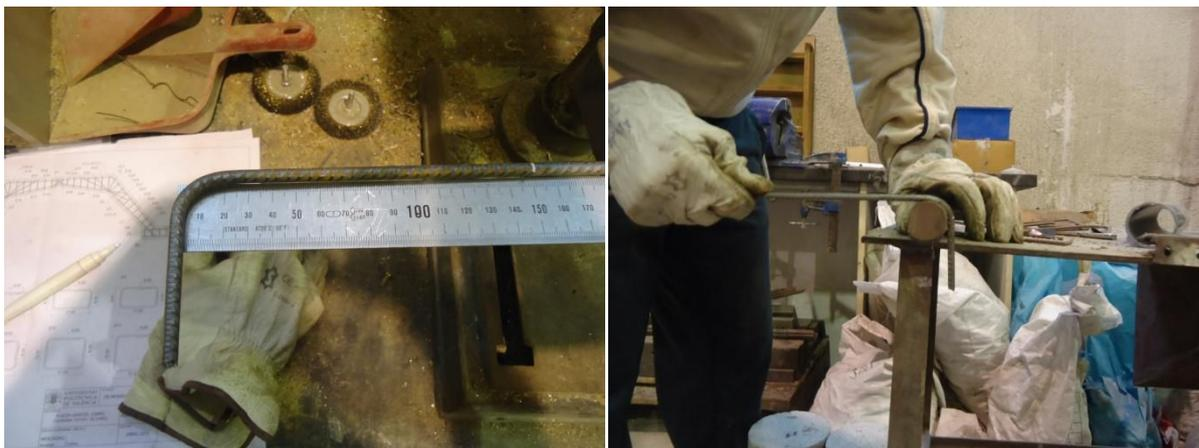
**Figura 8.6.** a) Marcado de las longitudes de los tramos rectos del cerco; b) Comparación del diámetro de doblado con un  $\varnothing 32$ .
