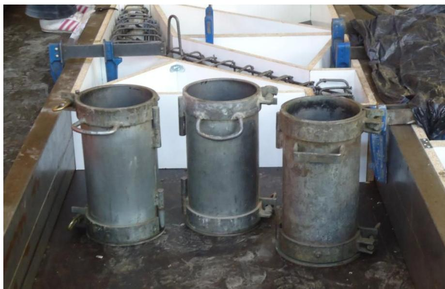
Figura 8.21. Moldes para probetas cilíndricas.
