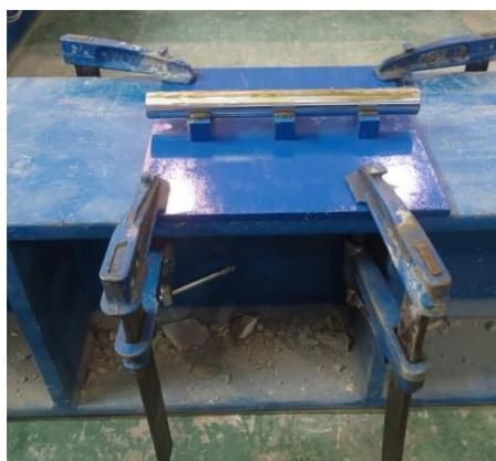
**Figura 9.4.** Aparato de apoyo deslizante fijado en el pórtico de carga.
