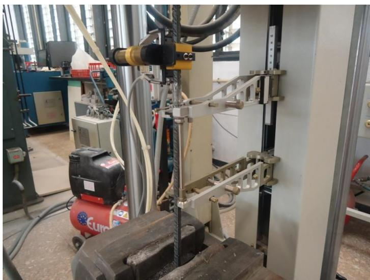
**Figura 5.20.** Probeta de ensayo en la cual se han colocado los captadores de 50 y 100 mm.
