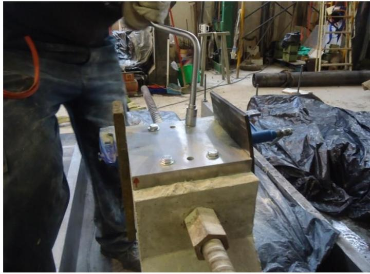
**Figura 9.1.** Fijación de placa de reparto en el apoyo derecho.
