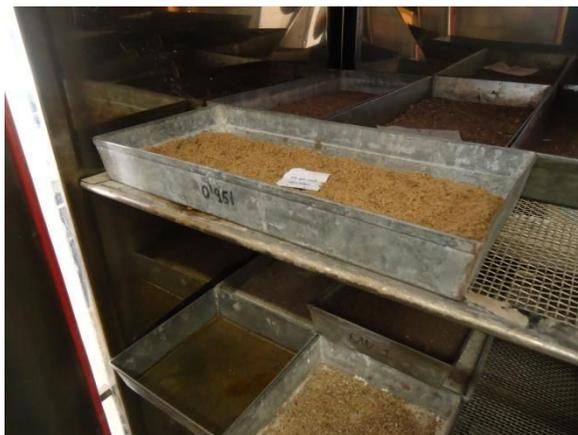
**Figura 5.2.** Introducción de la bandeja en la estufa.
