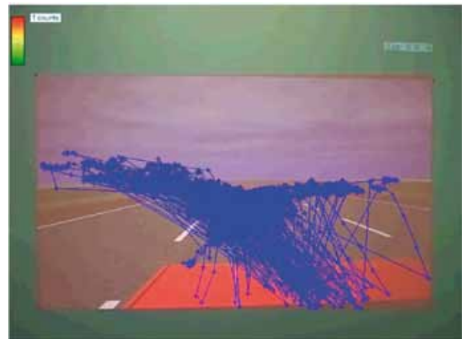
Figura 4. Seguimiento de la mirada durante la conducción del vehículo y el uso del sistema de climatización. Las trayectorias de la mirada (puntos y líneas azules) indican un enfoque de la atención a la parte central del carril y las señales a los lados de la carretera, más algunas desviaciones hacia el interfaz del sistema (miradas que se apartan hacia la derecha).
