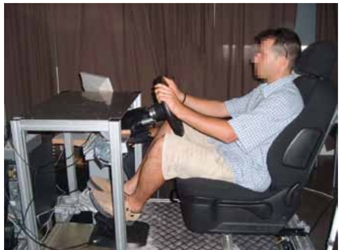
Figura 2. Pruebas con el pedal háptico en simulador con bastidor ligero.
