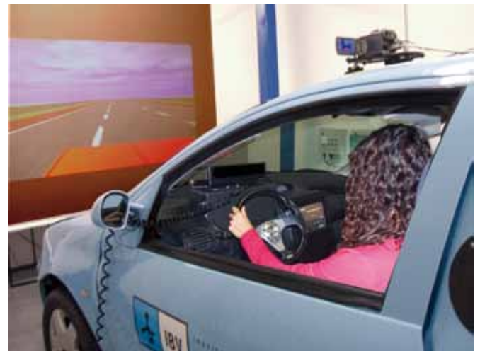
Figura 3. Pruebas con el sistema de climatización en simulador con carrocería completa.
