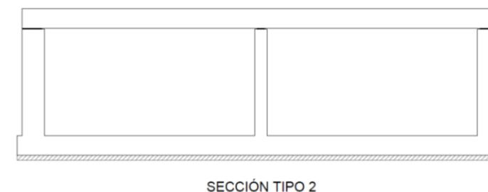
Mientras que la sección tipo 2 corresponde al tramo del colector que discurre bajo el parking.
