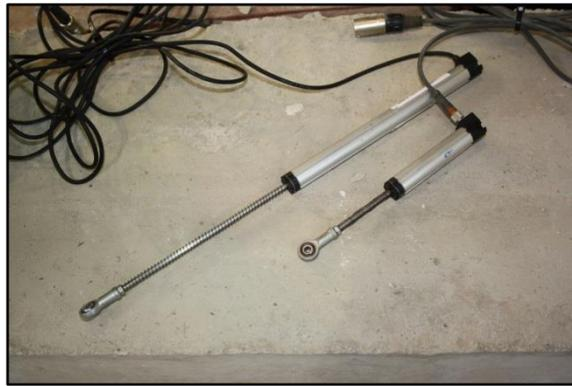
Fig 4.4.2.1 Captadores de desplazamiento
