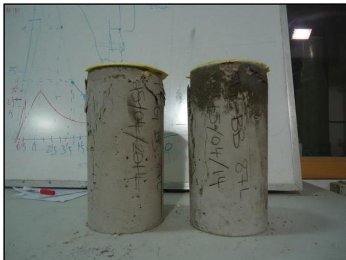
Fig 4.6.1.1 Probetas de control amasada 87l
