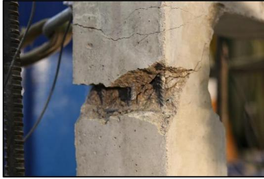
*Fig 5.1.1.10 Detalle rotura pilar izquierdo*
