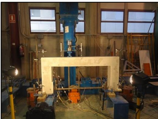
Fig 4.5.1 Colocación del elemento en el pórtico de ensayo
