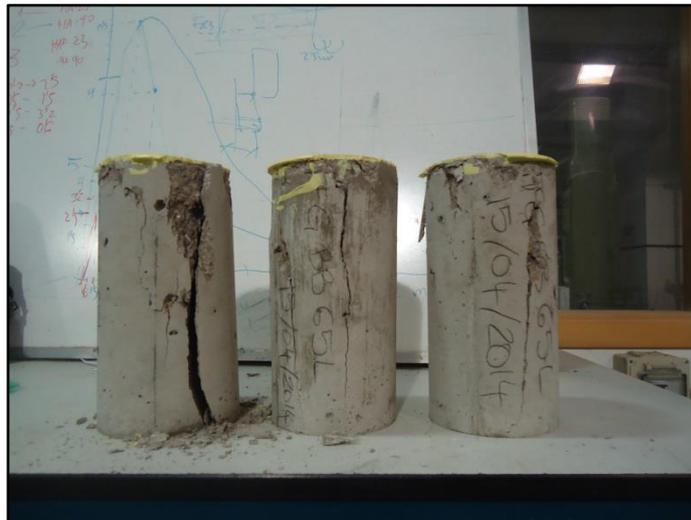
Fig 4.6.1.2 Probetas de control amasada 65l
