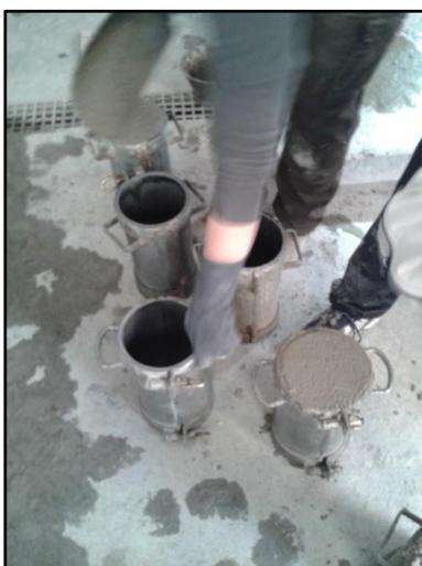
Fig 2.2.2.3 Llenado de probetas segunda prueba
