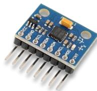
Figura 2.7. Sensor de aceleración y rotación
