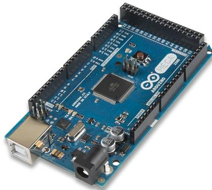
Figura 2.1. Arduino Mega 2560
