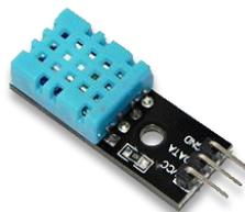
Figura 2.2. Sensor de temperatura y humedad DHT11
