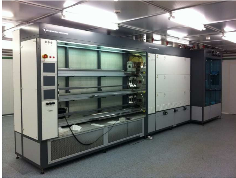
Figura 11- Imagen del equipo de difusión utilizado en la línea piloto de Siliken suministrado por Tempres Systems.
