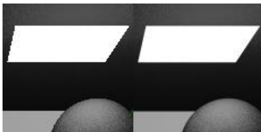
Figura 10. Imagen con aliasing (izquierda) frente a imagen sin aliasing (derecha).
