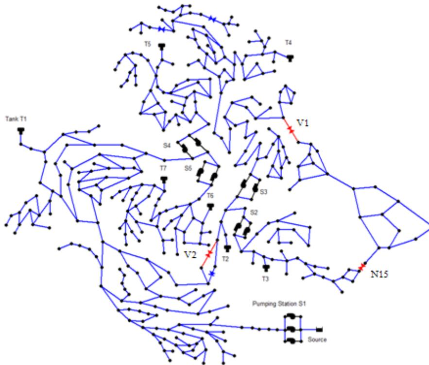
Figura 35. En rojo, válvulas que se consideran relevantes en la resolución del problema.
