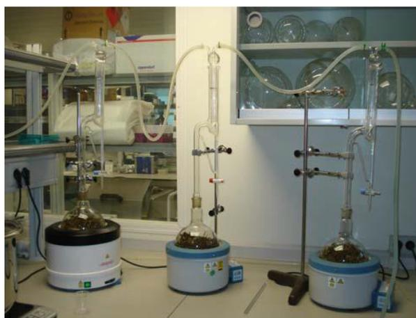
Obtención de aceite esencial mediante un destilador tipo Clevenger
