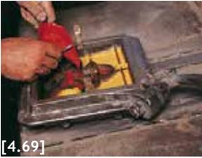
[4.69] Partes de la baldosa hidráulica y molde con trepa para el prensado y fabricación.
