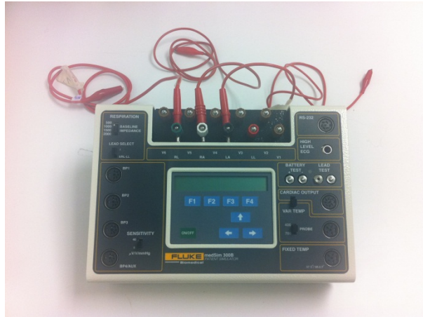
Figura 33 Simulador de ECG fluke Biomedical
