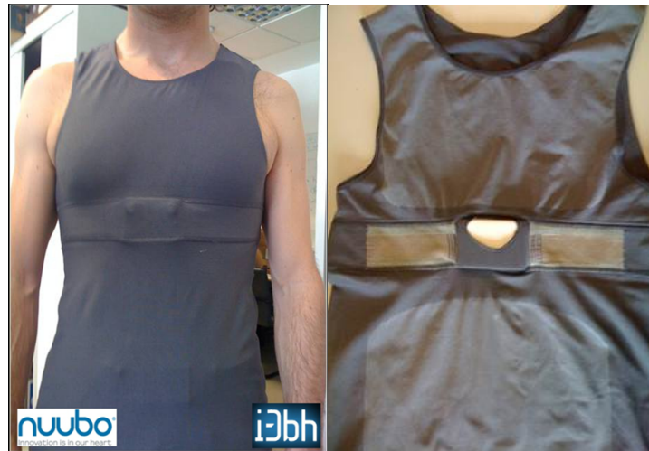
Figura 25 Camiseta biomédica de NUUBO (TIPS shirt). A la derecha electrodos (zona gris) integrados en la camiseta.
