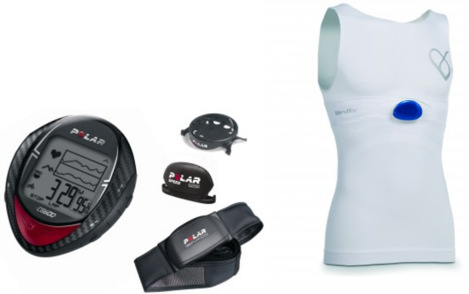
Figura 15 Dispositivos portátiles de monitorización cardíaca. (izqda: Banda pulsómetro de polar, dcha: camiseta de monitorización cardíaca de la empresa Nuubo).
