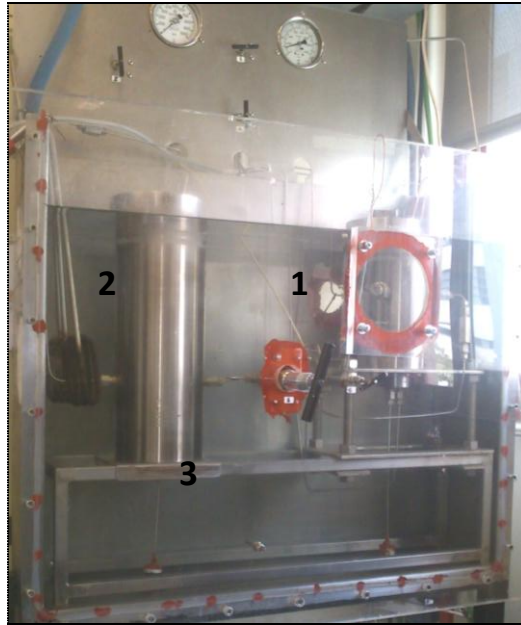
Fig. 3.8. Depósito de tratamiento y elementos auxiliares. 1: Baño termostático; 2-resistencia eléctrica; 3-depósito de tratamiento.
