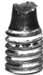
Figura 4.47. Sección longitudinal de la zona de rotura y detalle de la probeta para la aleación I-Base solubilizada a 1200 °C y ensayada a fluencia a, a.1) y a.2) 300 MPa (108 h) y b.1) y b.2) 125 MPa (1286 h).
