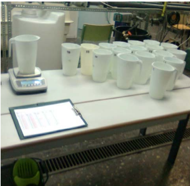
Imagen 5: Estimación gravimétrica del caudal arrojado por los emisores
