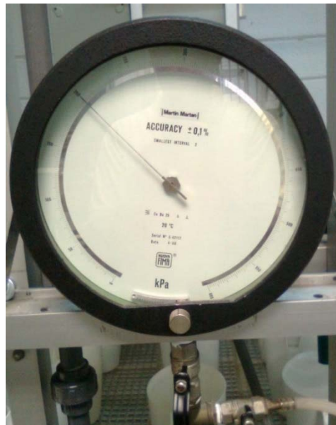
Imagen 3: Manómetro de precisión para medir la presión de ensayo
