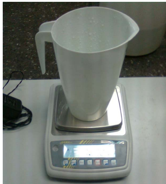
Imagen 5: Estimación gravimétrica del caudal arrojado por los emisores
