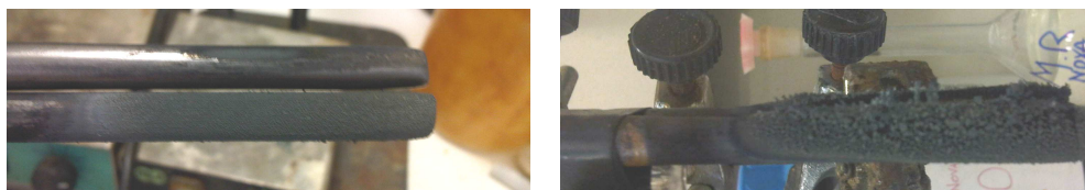
Fig. 3.9: Imágenes de los depósitos obtenidos a -1.25V , izquierda, y a -1.5V , derecha.
