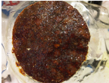
Fig. 4.35: Aspecto de la NAFION-117, cara anódica, después de los ensayos realizados por encima de la intensidad límite, I = -1750\text{mA} .
