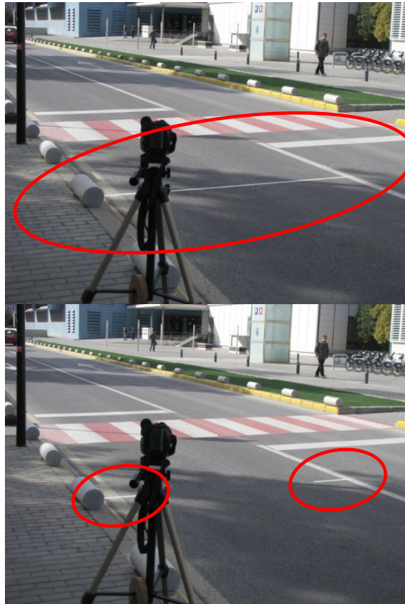
Figura 61. Marcas viales para determinar velocidad de los vehículos.
