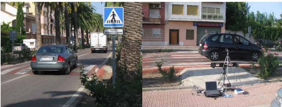
Figura 80. Toma de datos para moderador tipo paso peatonal elevado en Albalat de la Ribera, Valencia.
