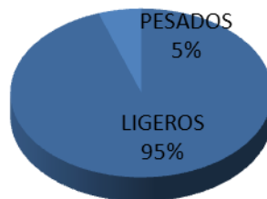
Figura 105. Porcentajes de vehículos en la primera toma de datos sobre el resalte prefabricado en primera prueba.
