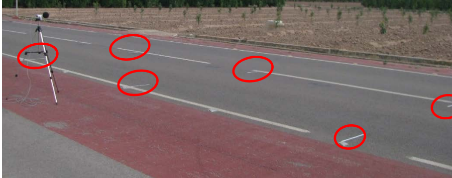
Figura 62. Marcas viales para medición de velocidad.
