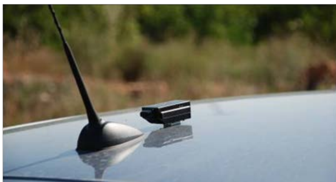
Figura 46. Dispositivo GPS instalado en los vehículos de las pruebas de velocidad.
