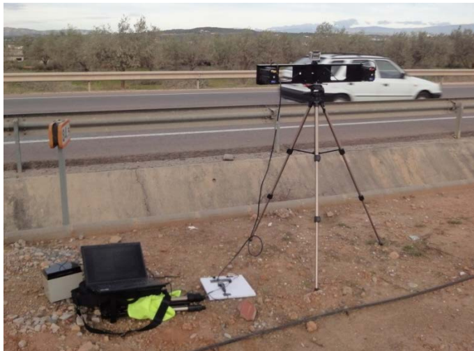
Figura 57. Equipo de medición de velocidad Speed System T100/T200.
