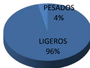
Figura 127. Porcentajes de vehículos en la toma de datos sobre el paso elevado extremo.
