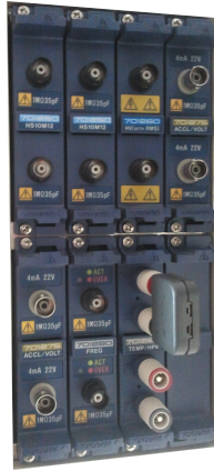
Figura 4.24: Tarjetas incluidas en el osciloscopio utilizado en el banco de ensayos.
