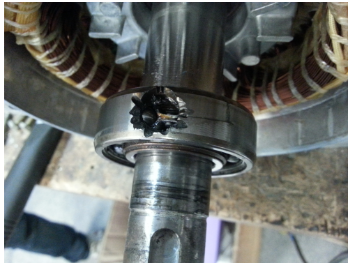
Figura 4.7: Cojinete deteriorado del motor ensayado.
