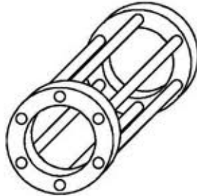
Figura 3.2: Barras y anillos de cortocircuito que conforman un rotor de jaula de ardilla.
