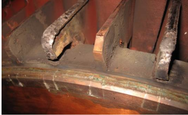
Figura 4.5: Rotura parcial de barras en la unión barra–anillo de cortocircuito en un motor asíncrono de rotor jaula de ardilla ( P = 3,2MW ).
