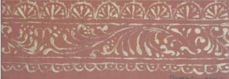
Figura 65. Probeta realizada con el aglutinante: adhesivo nitrocelulósico.
