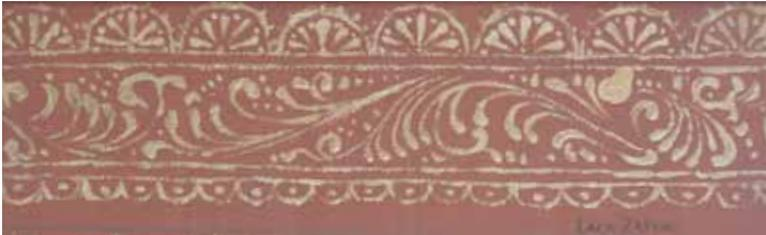
Figura 62. Probeta realizada con el aglutinante: Laca Zapón.
