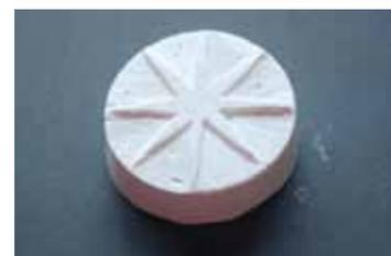
Figura 75 y 76. Cuño realizado sobre escayola en forma de estrella para la realización de la probeta.
