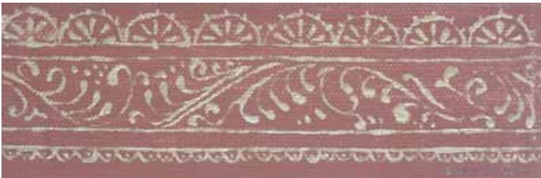
Figura 68. Probeta realizada con el aglutinante: resina sandárac.
