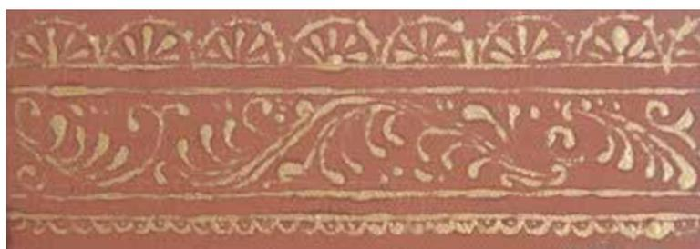
Figura 71. Probeta realizada con el aglutinante: resina de almáciga.
