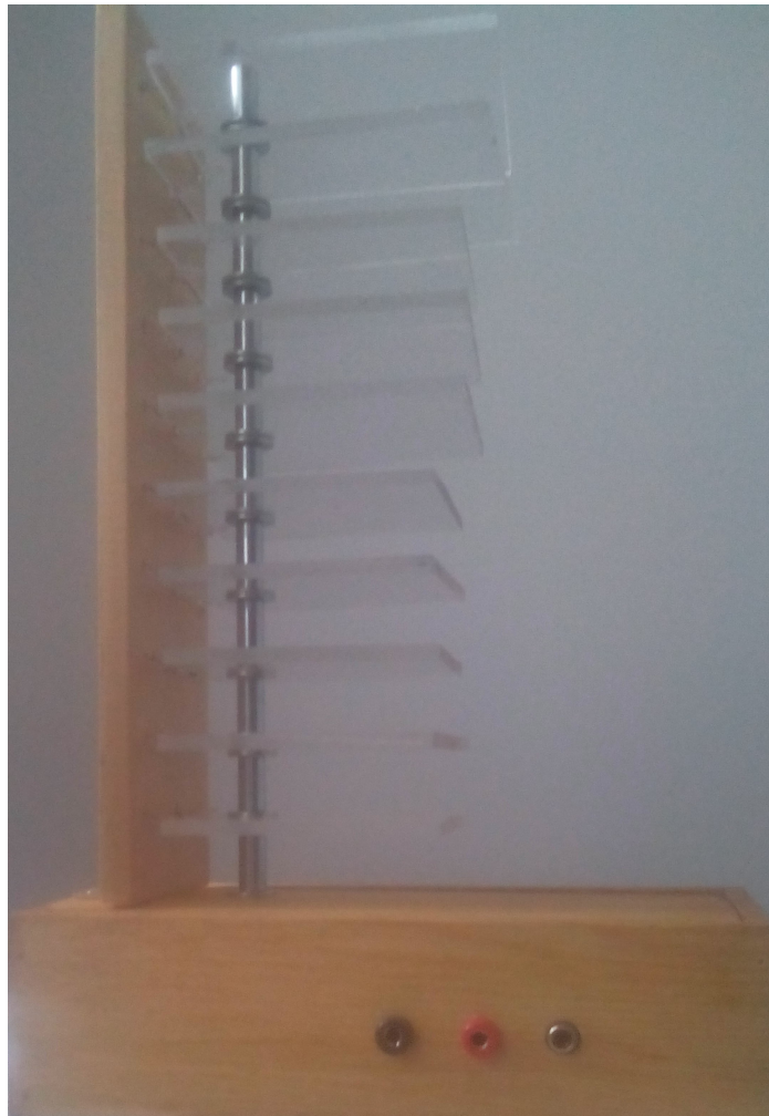
Figura 52 Leds incrustados en el metacrilato y conectores banana-hembra y conector RCA-hembra
