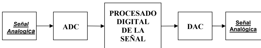
Figura 5 Esquema de funcionamiento básico del DSP.
