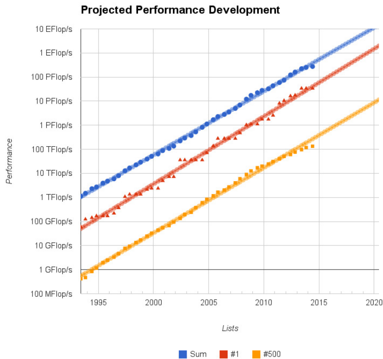
Figura 1.4: Tendencia seguida en el rendimiento de los sistemas HPC presentes en el Top500 (Fuente top500.org)
