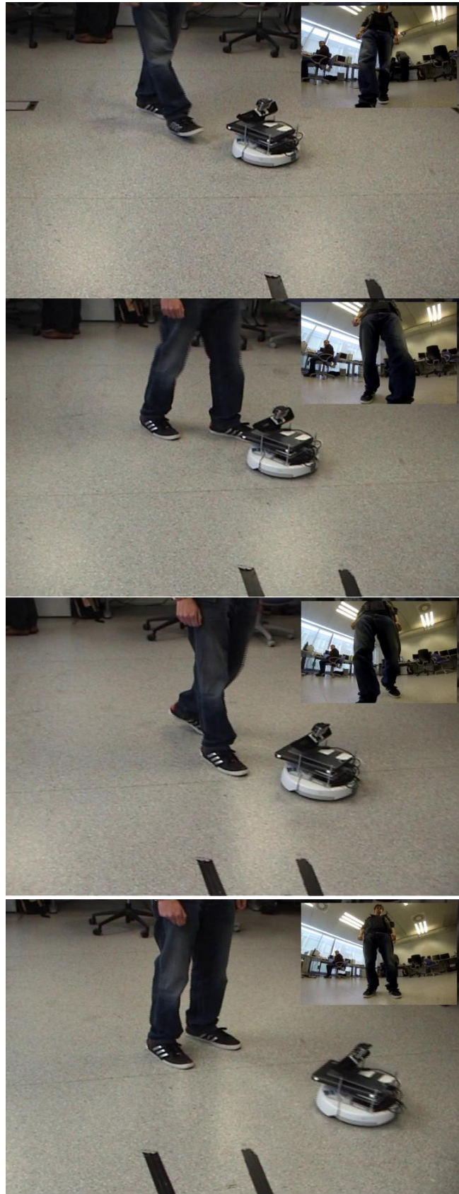
Ilustración 57 Robot seguidor. Se puede apreciar que el robot se moverá para mantener una distancia constante al usuario.
