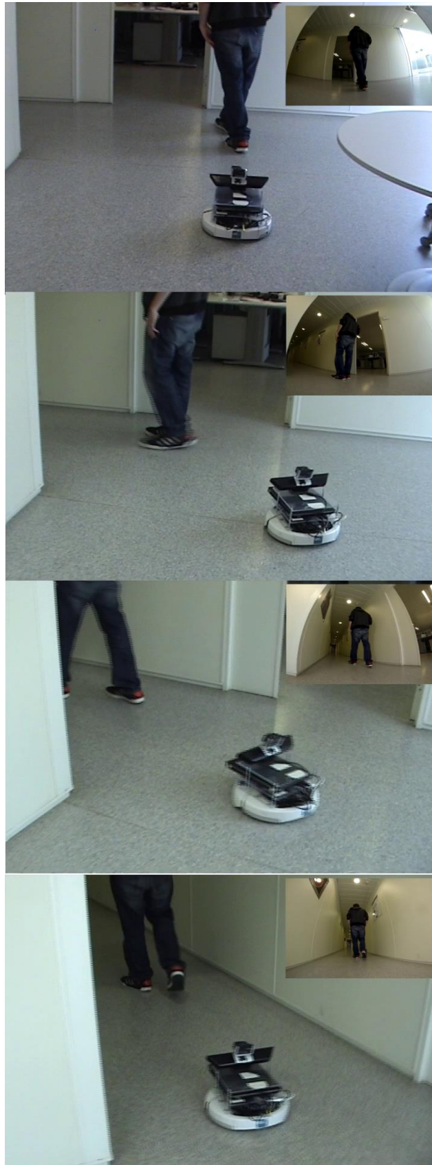
Ilustración 58 Nodo seguidor. En esta secuencia de imágenes se observa como el robot sigue el movimiento del usuario por las esquinas y pasillos.
