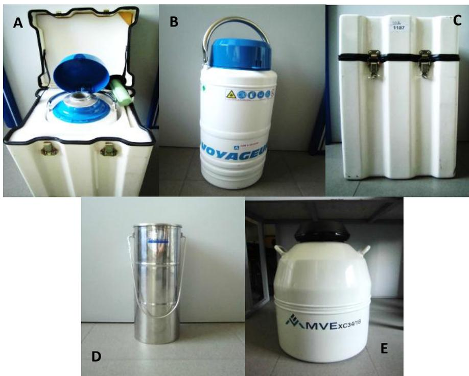
Figura 1. Tipos de bancos criogénicos. (A, B y C) Banco seco de nitrógeno para transporte. (D) Banco de trabajo o frasco Dewar. (E) Banco de almacenamiento de muestras.
