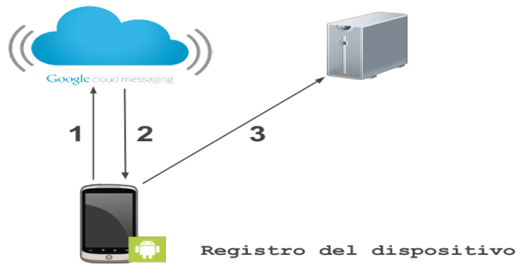
Figura 5.1: Proceso de registro en Google Cloud Messaging.
