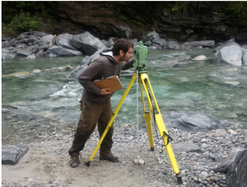
Toma de mediciones in situ con la estación total
