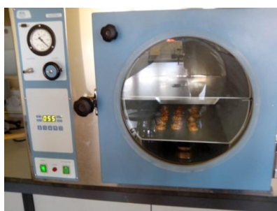
FIGURA 5. Estufa de vacío que se utilizó para la determinación de humedad con las respectivas muestras en su interior.
