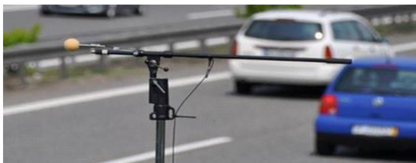
Figura 26: Metodo statistico pass-by per la misura del rumore
