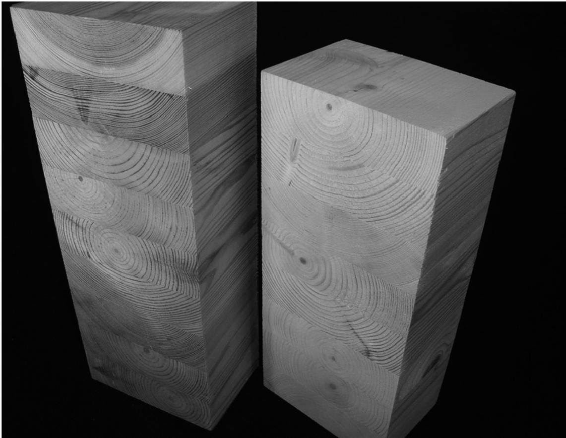
*Imagen 23: elementos de madera laminada encolada*
