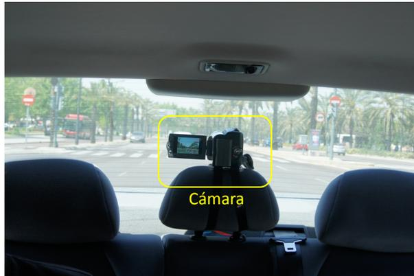
Figura 4.13: Instalación de la cámara a bordo del vehículo Rx.
