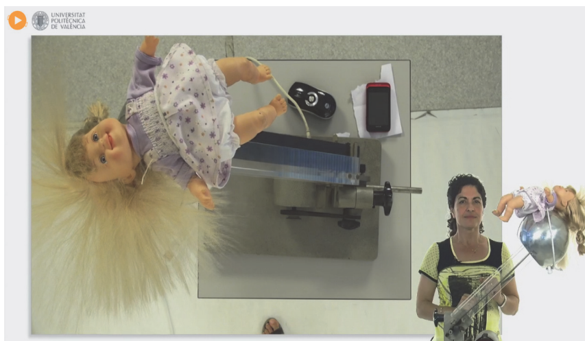
Fig. 2. Imagen de de una de las experiencias de aula haciendo uso del generador de Van der Graaf y mostrando todos sus efectos gracias a la cámara cenital disponible en los recursos Polimedia de UPV[X]
