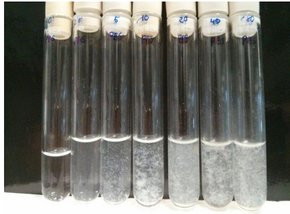
Figura 4.9. Tubos de la disolución de FA en PBS irradiados a distintos tiempos. De izquierda a derecha: 0, 2'5, 5, 10, 20, 40 y 80 minutos de irradiación.
