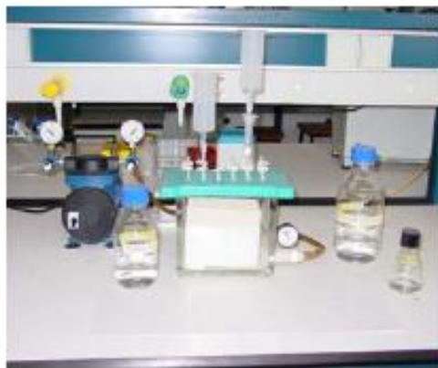
Figura 3. Sistema de extracción a vacío Extra Vac 12 (Scharlau) para cartuchos de SPE.
