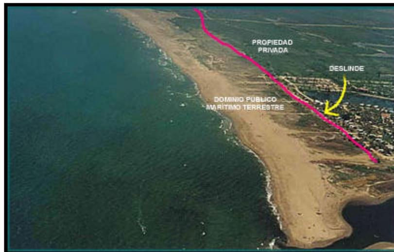
Figura II-6: Fotografía aérea con definición del deslinde de costas
