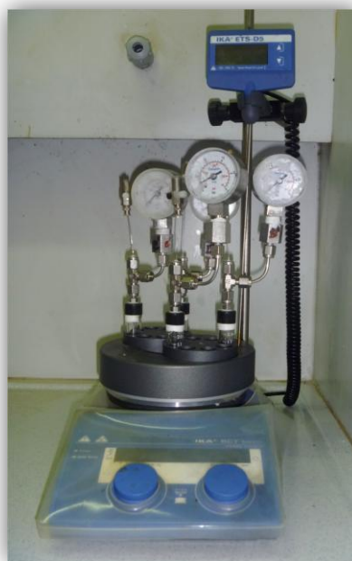
Figura 2. Montaje experimental para los diversos experimentos catalíticos con 2-metilfurano
