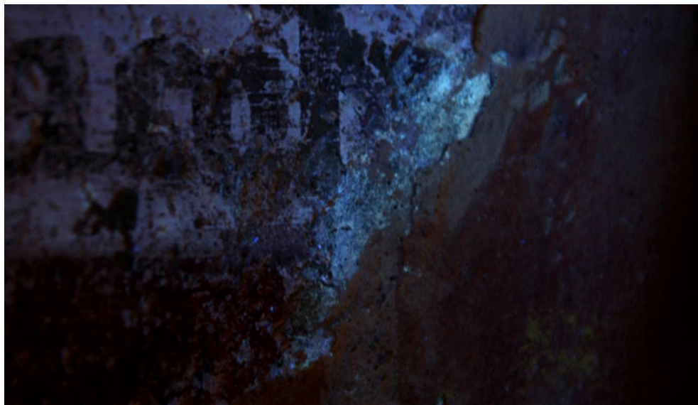
Figura 130 Giner Cordero E., Particolare di una reintegrazione e stuccatura sugli affreschi della navata con particolare fluorescenza ultravioletta che evidenzia la possibile presenza di sostanze proteiche sulla superficie. Chiesa di S. Carlo di Negrentino, Prugiasco. Fotografia a luce UV. 2007.
