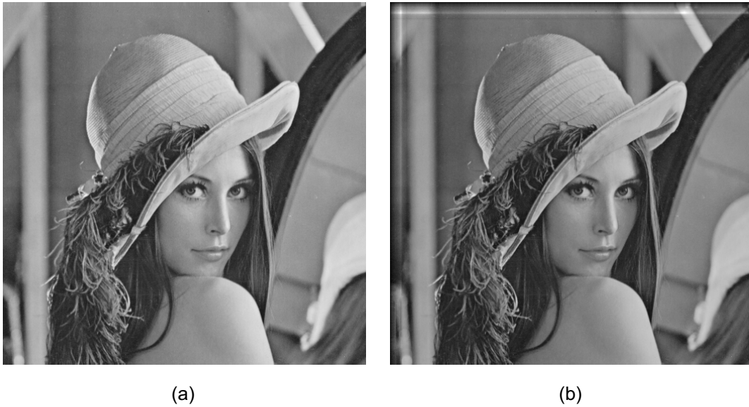
Figura 3.16. a) Imagen original. b) Efecto de bordes después de aplicar la DWT y restaurar con IDWT.
