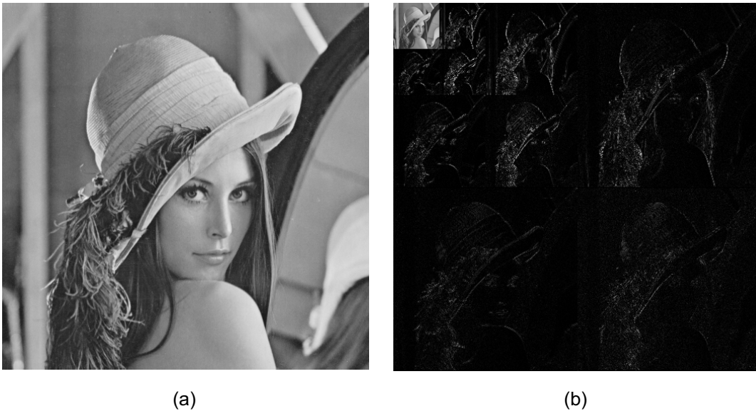
Figura 3.15. a) Imagen original. b) Resultado tras aplicar tres niveles de transformada wavelet.
