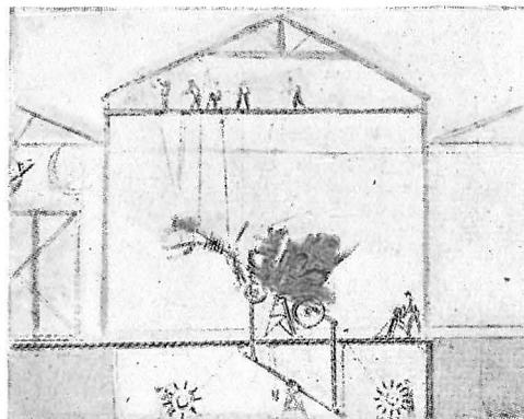
Y este es el croquis, dibujado por Méliès, en el que se puede apreciar el balancín ideado por éste y la disposición de la diligencia para ser manejada, "invisiblemente", desde el foso y desde arriba.
