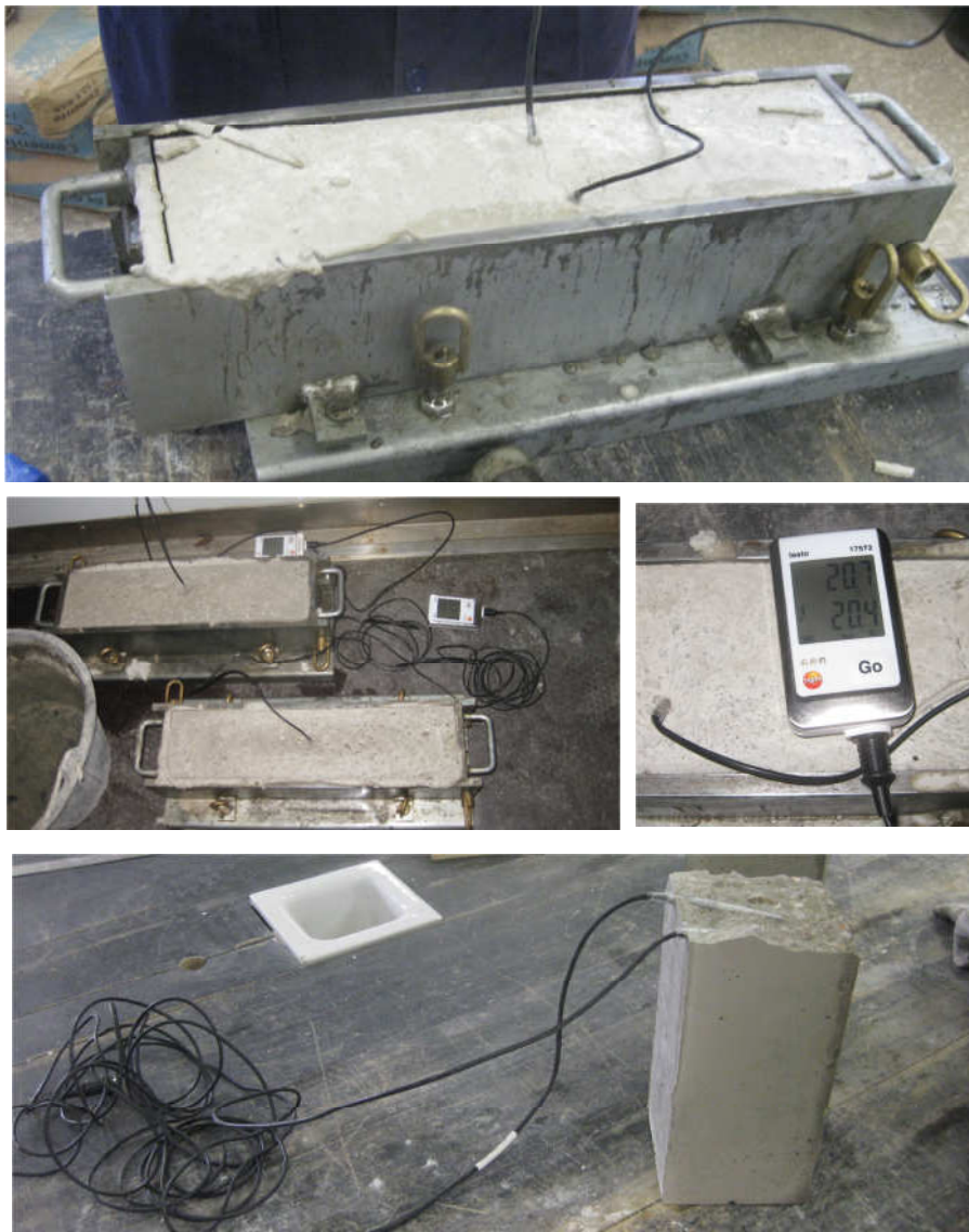
Figura 6.70. Vistas de probetas con sondas térmicas instaladas
