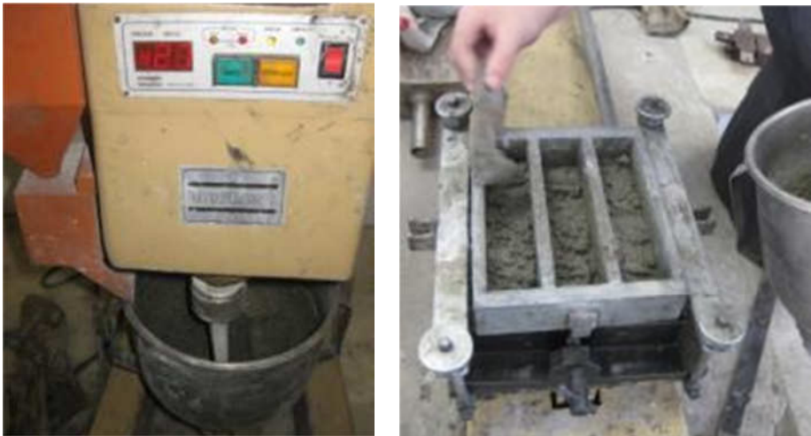
Figura 5.21. Amasado del mortero y relleno del molde por tongadas
