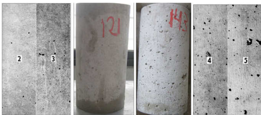
Figura 6.40. Izquierda H-20-1a con CIB=3,35%. Derecha H-20-3e con CIB=4,85%
