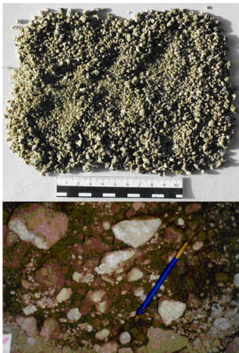
Figura 3.2. Escoria granulada arriba, cristalizada abajo ( www.cedexmateriales.vsf.es )
