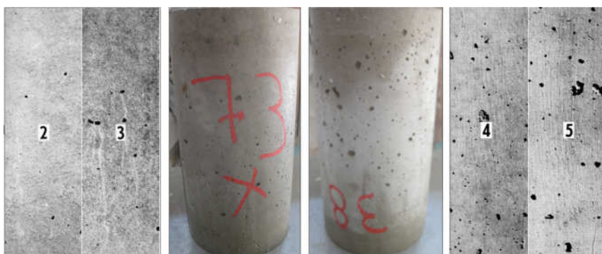
Figura 6.42. Izquierda H-40-2h con CIB=4,31%. Derecha H-50-2g con CIB=4,45%
