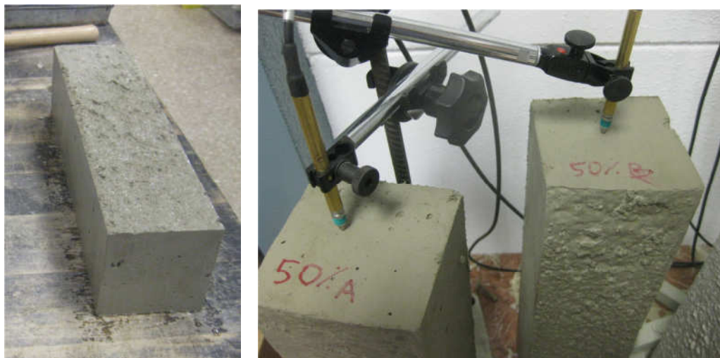
Figura 6.72. Izquierda, probeta desmoldada tras acabar el fraguado. Derecha, instalación en el dispositivo de control digital midi LOGGR GL220 ( \mu\text{m} )
