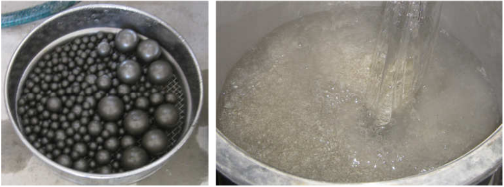
Figura 5.23. Equipamiento para la determinación del coeficiente de Micro-Deval. Material abrasivo a la izquierda, derecha llenado de agua con los áridos
