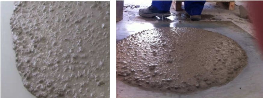
Figura 2.22. Izquierda, buen reparto de árido en el avance del fluido. Derecha ensayo de escurrimiento con síntomas de exudación
