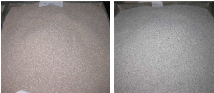
Figura 5.6. Material seleccionado entre 1 y 2 mm. Izq. árido calizo, derecha EGAH
