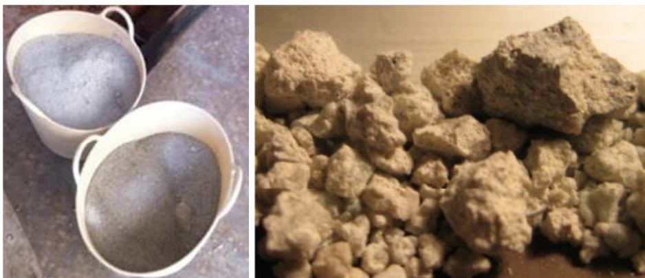
Figura A1.2. Escorias granuladas en recipiente a la izq. A la derecha vista ampliada
