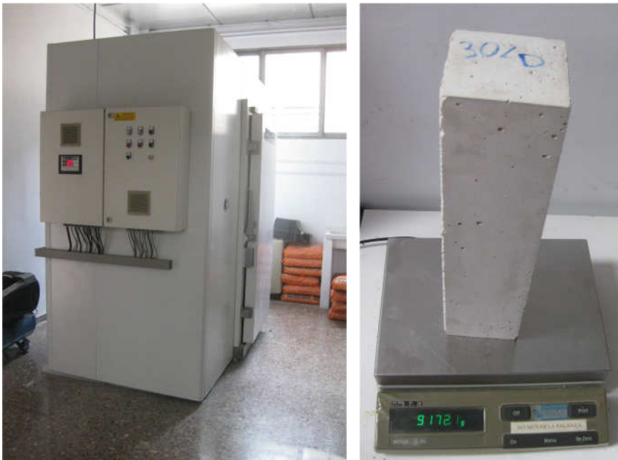
Figura 5.59. Izquierda, cámara climática modelo CTS. Derecha, balanza de pesaje
