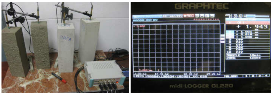
Figura 5.61. Derecha, montaje de las probetas con los sensores, unidad central y de amplificación. Izquierda, detalle de la unidad de control modelo midi LOGGR GL220 de la marca GRAPHTEC
