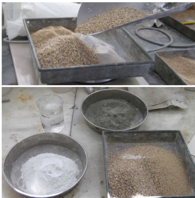
Figura 5.19. Arriba, pesada de los 3 áridos síliceos. Abajo, totalidad de elementos
