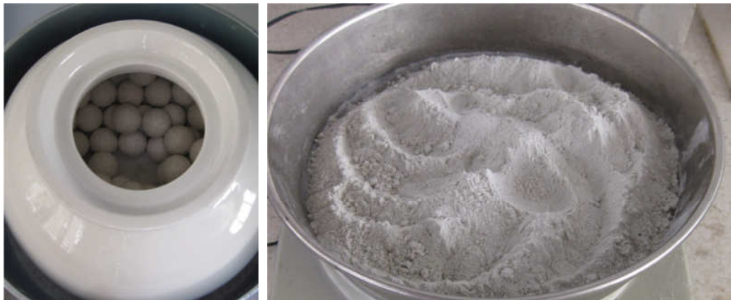
Figura A2.6. Izquierda, molienda de la escoria. Derecha, escoria molida
