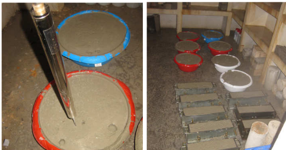
Figura 6.66. Izquierda, dispositivos realizando ensayo. Derecha, vista de las 7 muestras en la cámara de curado, en iguales condiciones de curado que las probetas utilizadas
