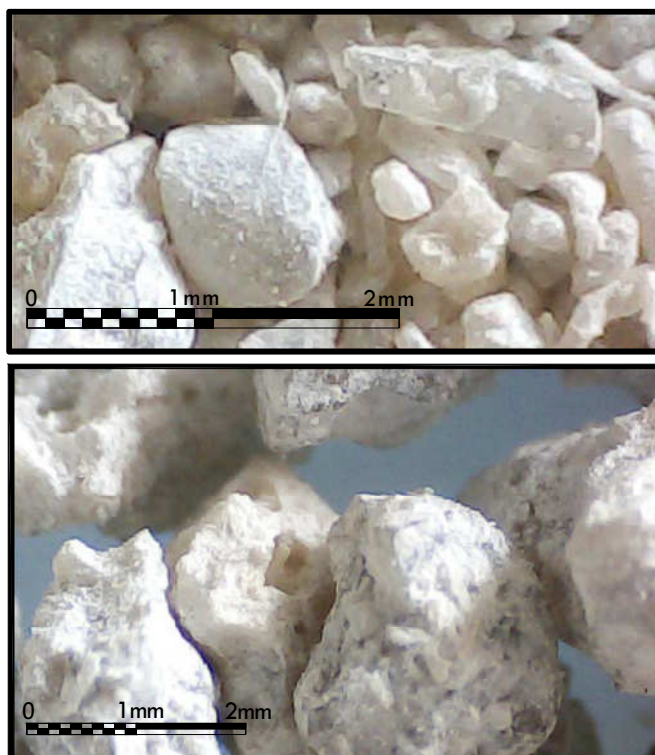
Figura 5.1. Micrografías de unas muestras de escoria granulada de alto horno
