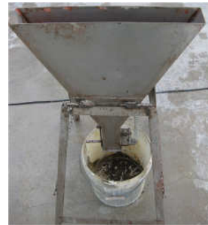
Figura 2.24. Ensayo de embudo en V
