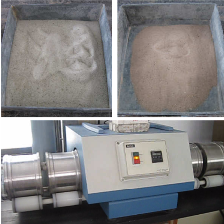
Figura 5.22. Arriba muestras a estudiar arriba (izquierda EGAH y derecha arena caliza), abajo dispositivo para coeficiente de Micro-Deval
