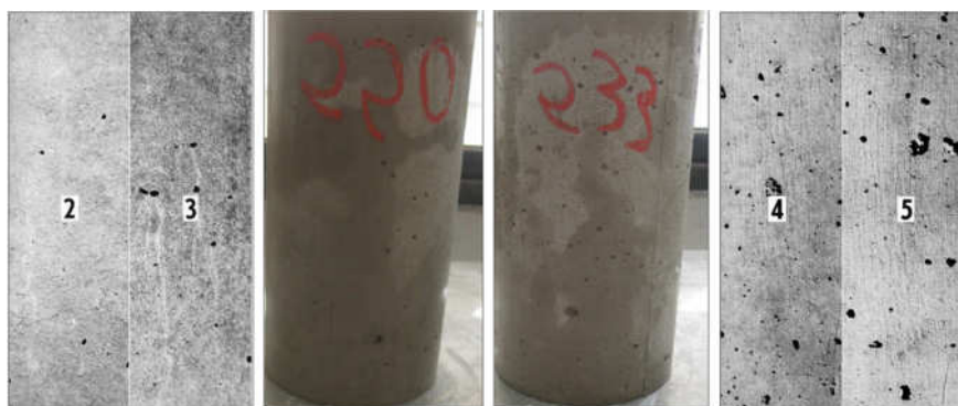
Figura 6.43. Izquierda H-60-2a con CIB=2,65%. Derecha H-60-3d con CIB=4,11%
