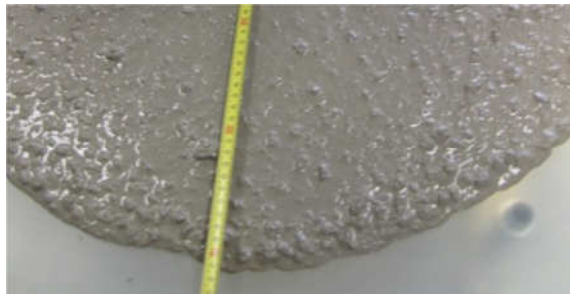
Figura 5.37. Ensayo de escurrimiento del H-0-2
