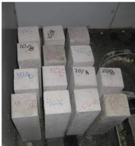
Figura 6.68. Probetas a controlar su pérdida de peso en el interior de la cámara climática
