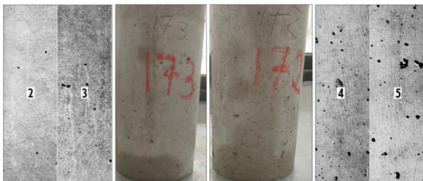
Figura 6.39. Izquierda H-10-3h con CIB=2,92%. Derecha H-10-3g con CIB=4,19%
