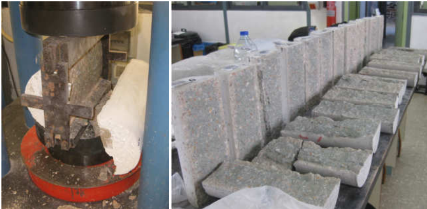
Figura 5.50. Izq. dispositivo del ensayo. Derecha, rotura de probetas
