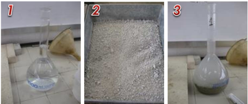
Figura 5.27. Determinación de la densidad de las escorias
