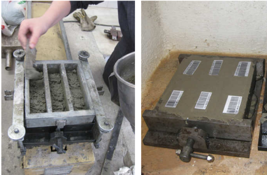
Figura A2.3. Izquierda, llenado de moldes. Derecha, probetas terminadas
