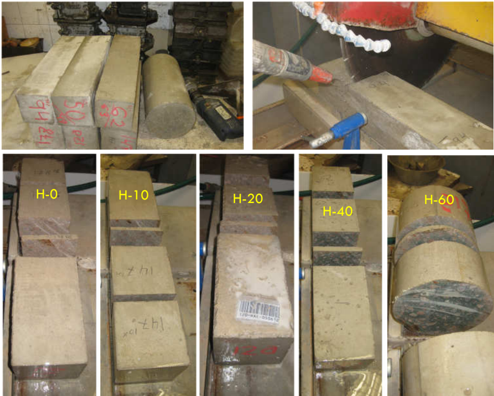
Figura 5.56. Arriba preparado de probetas, abajo corte de las mismas
