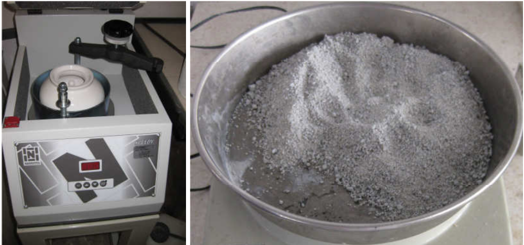
Figura A2.5. Izquierda, dispositivo de molienda. Derecha, la EGAH sin moler
