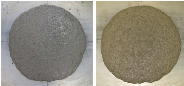
Figura 2.29. Izquierda y derecha HAC con VSI = 0 en el ensayo de escurrimiento
