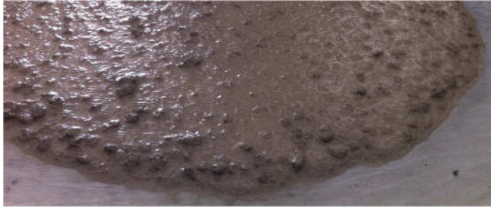
Figura 2.30. HAC con VSI = 1 en el ensayo de escurrimiento
