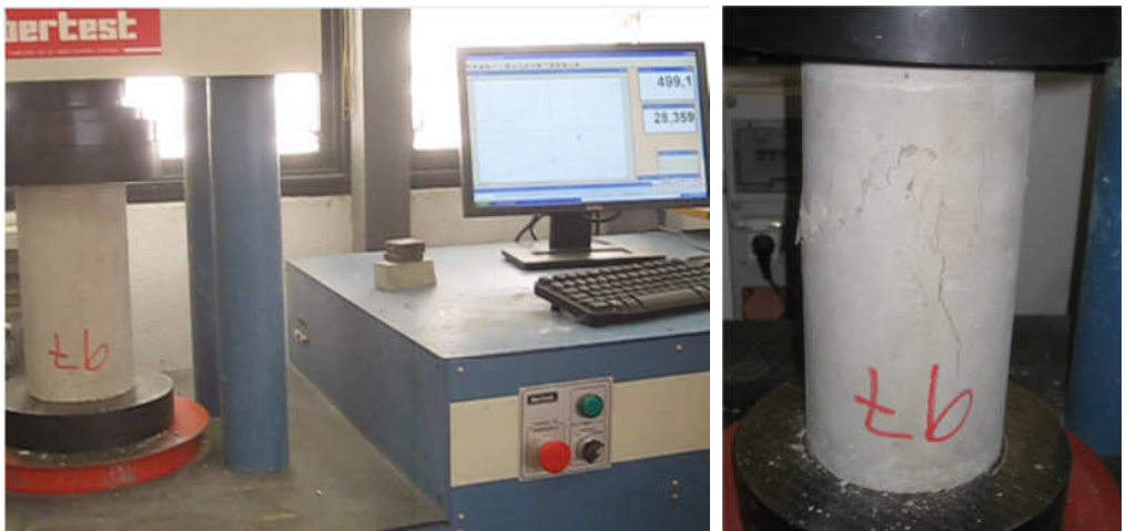
Figura 5.48. Izquierda dispositivo de ensayos mecánicos, derecha rotura de probeta
