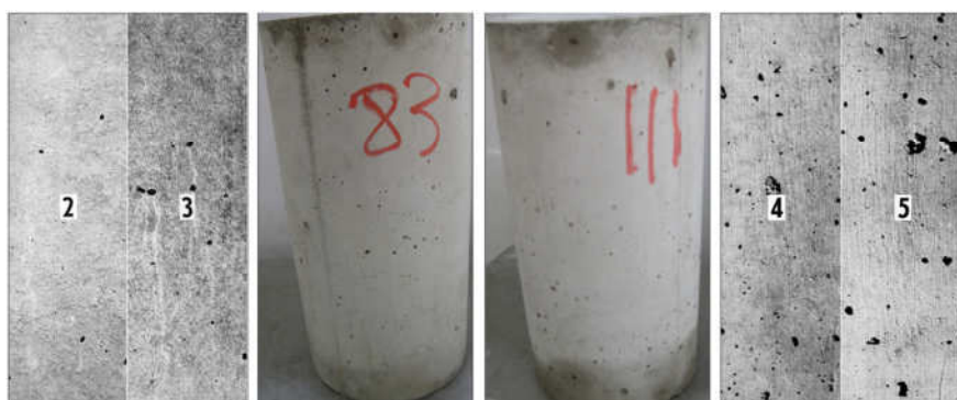
Figura 6.41. Izquierda H-30-1a con CIB=3,80%. Derecha H-30-3d con CIB=4,00%
