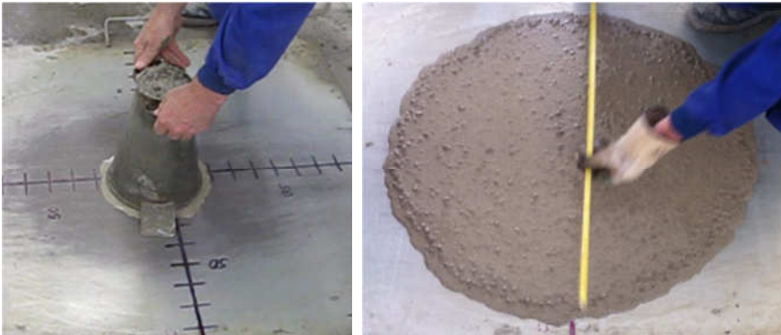
Figura 2.23. Izquierda, indicios de exudación en el llenado del cono. Derecha ensayo de escurrimiento con síntomas de exudación
