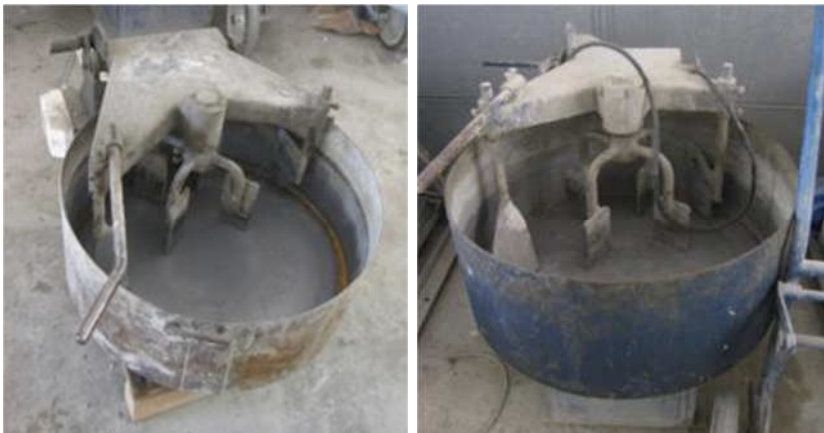
Figura A2.1. Amasadora de 20 litros a la izq. y de 60l a la derecha
