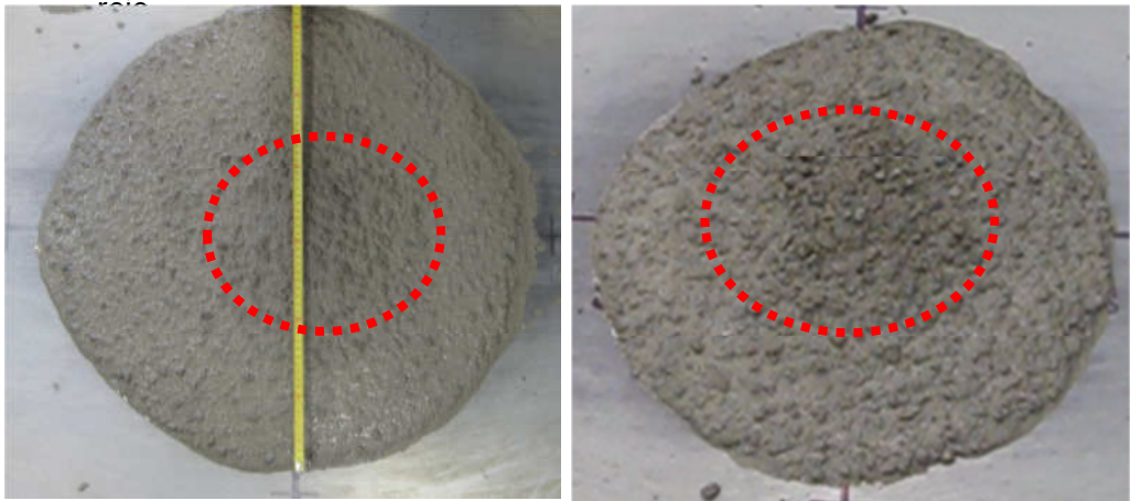
Figura 2.31. Izquierda y derecha HAC con VSI = 2 en el ensayo de escurrimiento, apreciando halo de exudación y acumulación de áridos en la parte central
