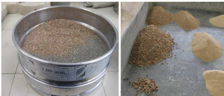
Figura A1.4. Izquierda, tamiz de 1 mm. Derecha, árido por diámetros
