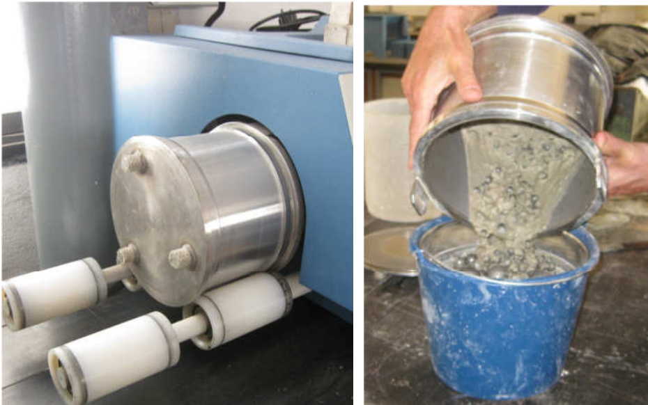
Figura 5.24. Tambor del dispositivo y retirada de la muestra tras 1.500 vueltas
