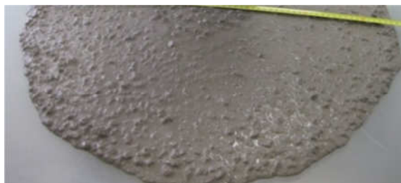
Figura 5.38. Ensayo de escurrimiento del H-0-3
