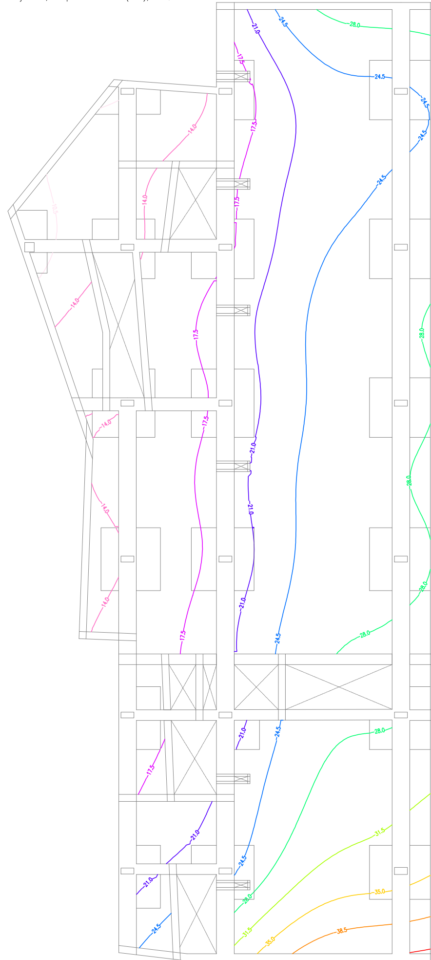
Forjado 4, Desplazamiento Z (mm), G+Qa
