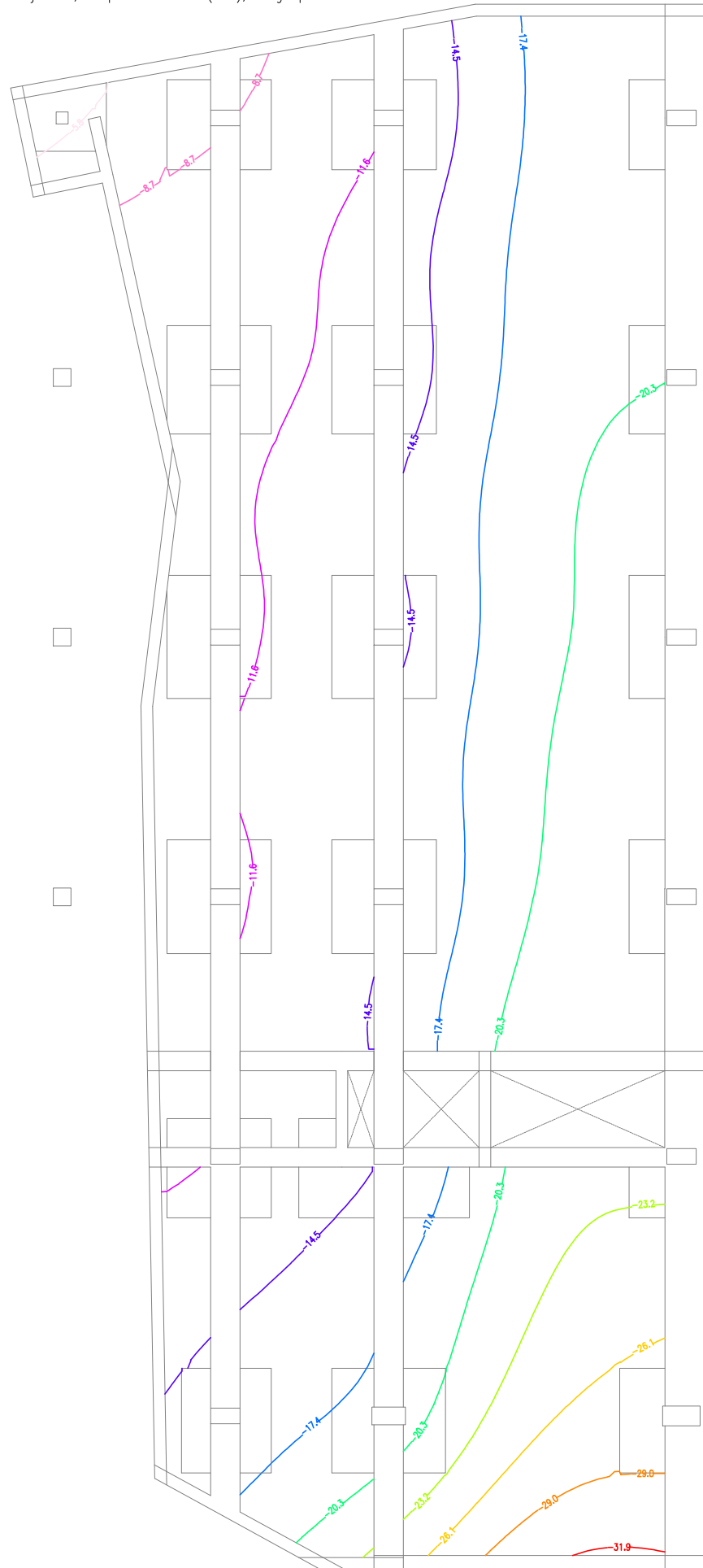
Forjado 1, Desplazamiento Z (mm), Carga permanente
