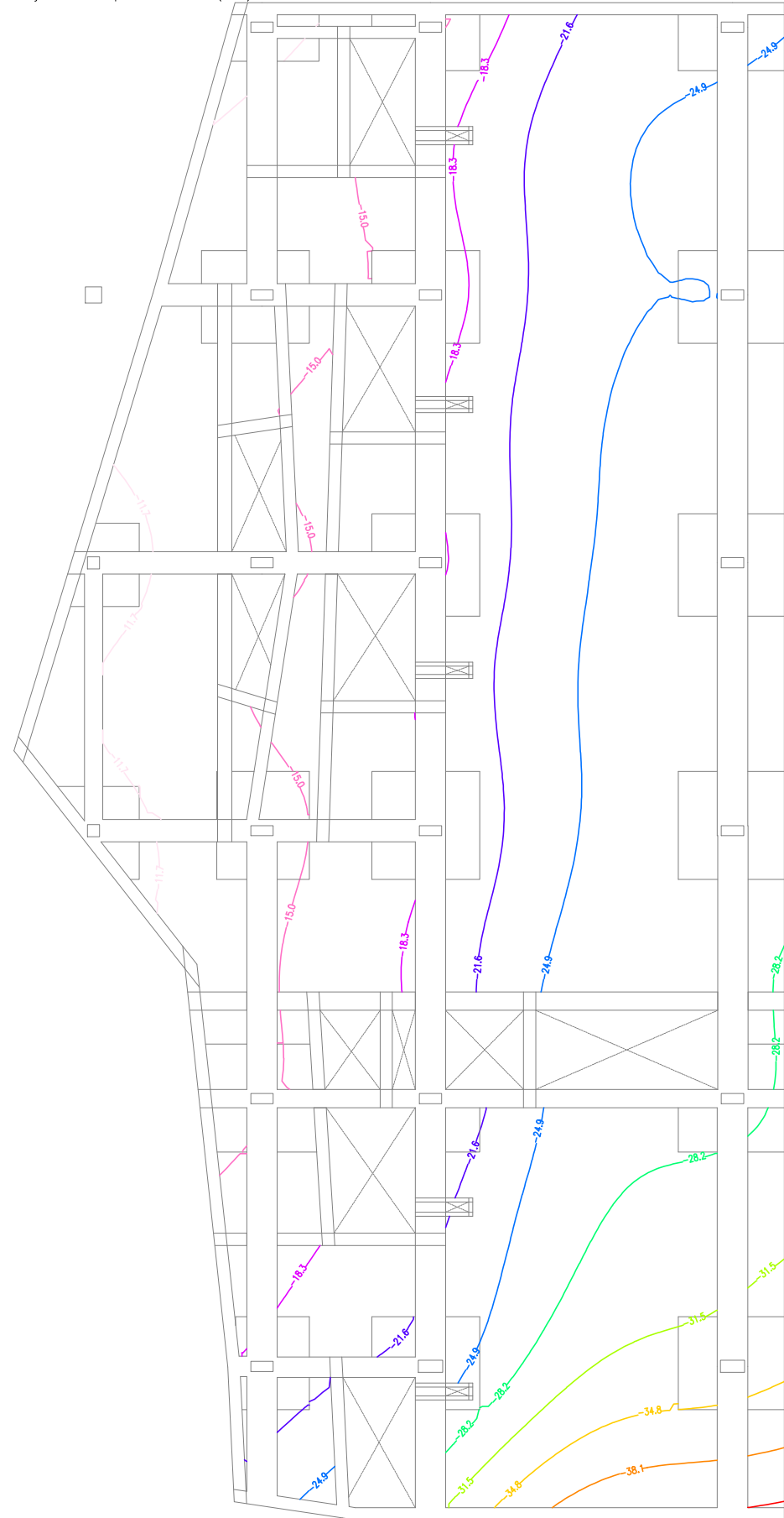
Forjado 3, Desplazamiento Z (mm), G+Qa
