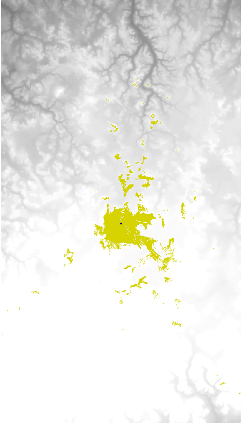
Figura 112. Cuenca visual desde Puerto Rico. La altura del ojo del observador es de 7m y la altura mínima del punto observado 0m.
