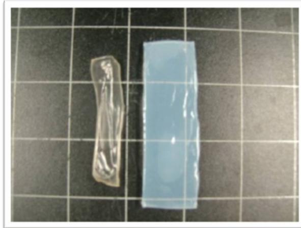
**Figura 5.45.** Efecto de la humedad sobre el volumen de un hidrogel.
