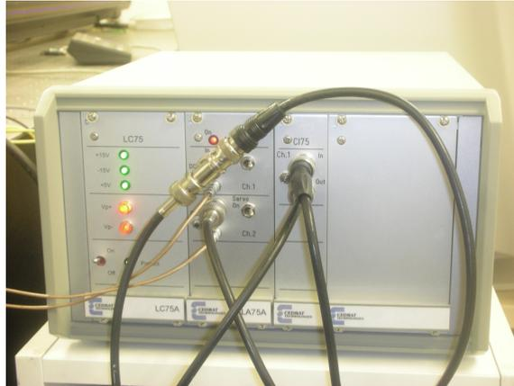
Figura 3.16. Adaptador de voltajes y desfaseador para el control de los actuadores piezo-eléctricos.
