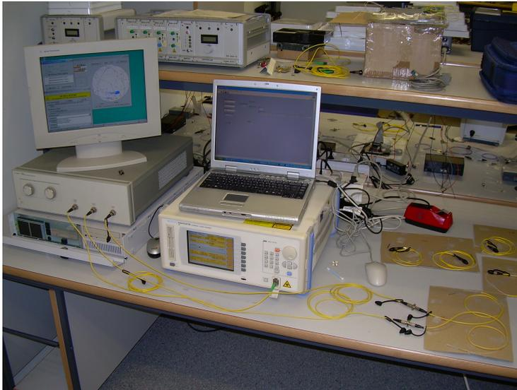
**Figura 4.6.** Imagen del montaje experimental para determinar la respuesta en polarización
