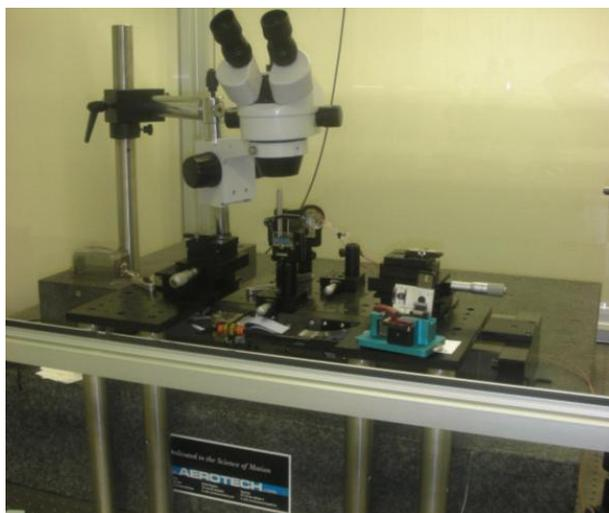
Figura 3.9. Plataforma de traslación.
