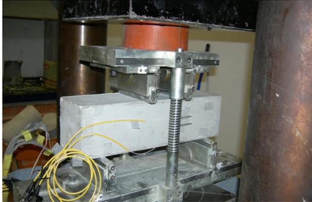
**Figura 5.40.** Probeta prismática de hormigón con el detalle de los sensores ópticos.
