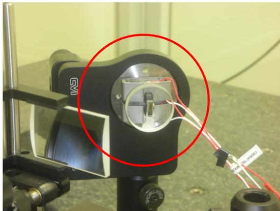
Figura 3.13. Espejo UV montado sobre actuadores piezoeléctricos.
