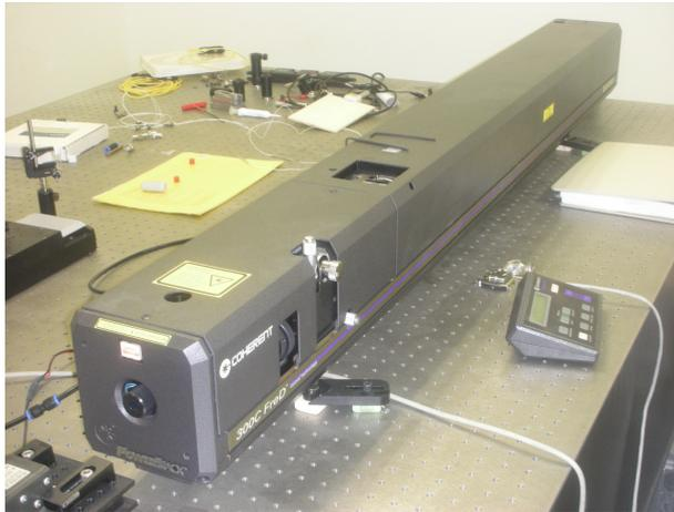
**Figura 3.4.** láser UV utilizado en el sistema de fabricación.
