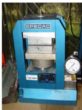
Fig. 4.2 Prensa con calentamiento programable para la obtención de los ensambles membrana electrocatalizador
