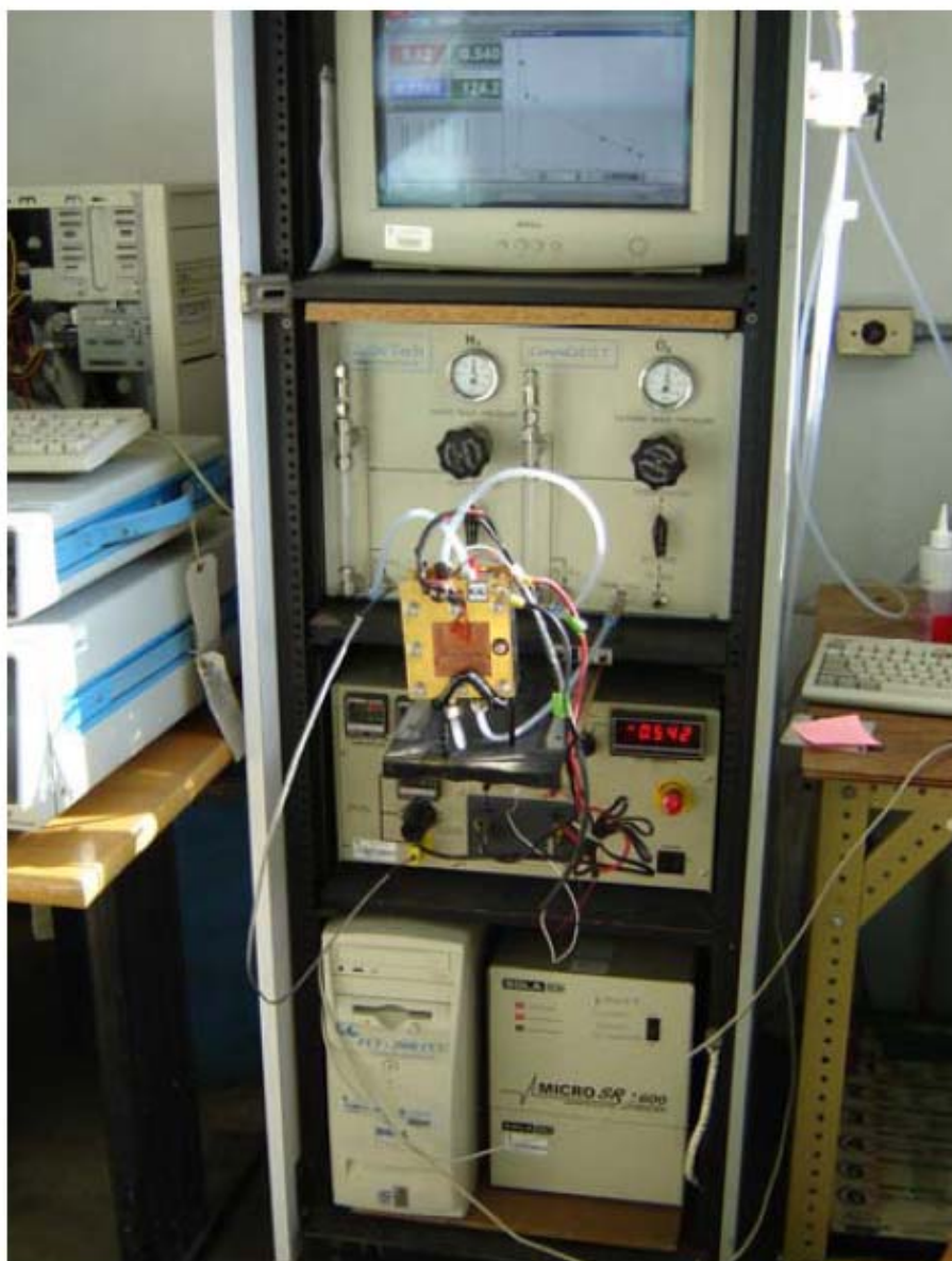
Fig. 4.10. Fotografía del sistema completo de pruebas de la monocelda (Fuel Cell Test System 890B de Electrochem)
