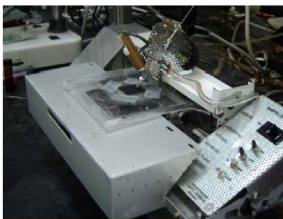
Fig. 4.1 Fotografía mostrando el dispositivo para la deposición de la tinta electrocatalítica sobre la membrana
