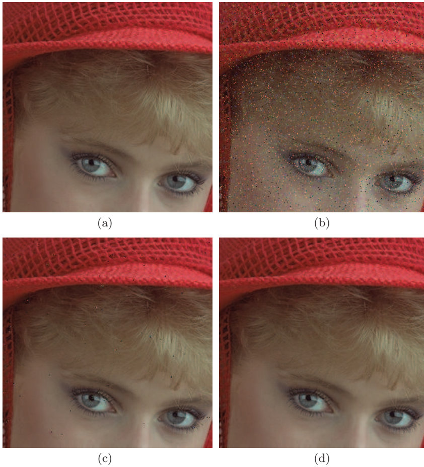
Figura 6.21. Comparatives per a la imatge Girl: (a) Imatge Girl original, (b) imatge Girl contaminada amb un 10% de soroll impulsiu. (c) sortida del filtratge IFPGF, (d) sortida de la implementació del IFPGF fuzzy .
