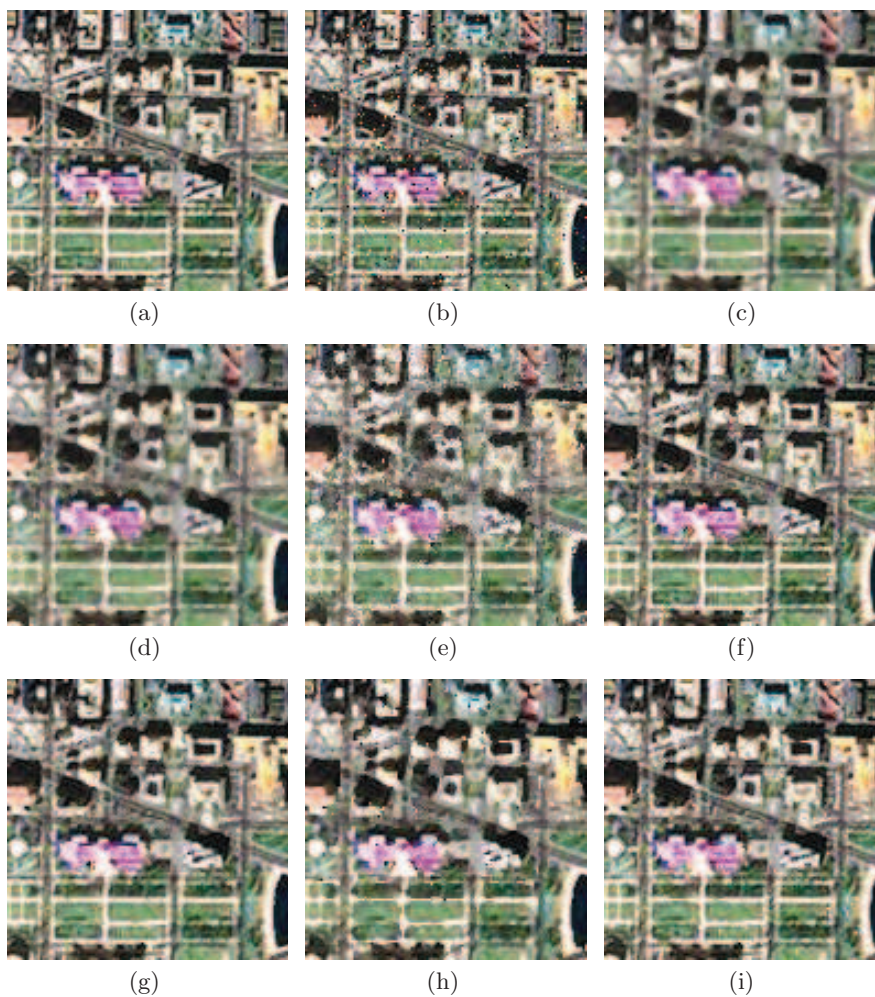
Figura 5.6. Imatges de Sortida: (a) Detall de la imatge Aerial1 original, (b) detall de la imatge Aerial1 amb 10% de soroll impulsiu, (c) sortida del filtre VMF, (d) sortida del filtre DDF, (e) sortida del filtre BVFD, (f) sortida del filtre FIVF, (g) sortida del filtre PGF_{m=2} , (h) sortida del filtre PGF_{m=3} , (i) sortida del filtre FMNF.
