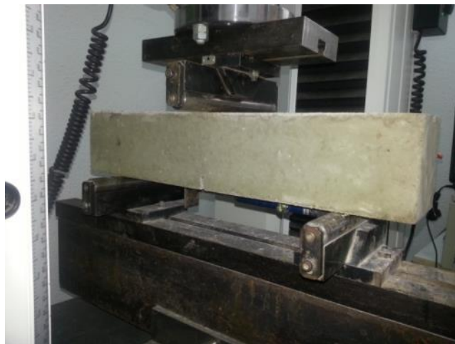
Ilustración 33: Probeta ensayada apoyada en 3 puntos con entalla central. Transductor de desplazamiento en la parte inferior de la viga.
