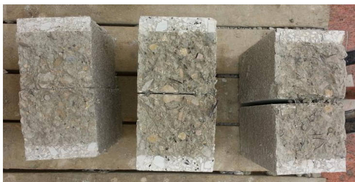
Ilustración 52: sección central de vigas después del ensayo a flexotracción
