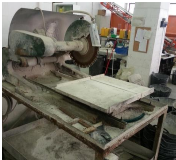
Ilustración 42: Cierra de corte en húmedo con cuchilla de diamante. Se utilizó para hacer las entallas de las probetas en ensayo de flexotracción.
