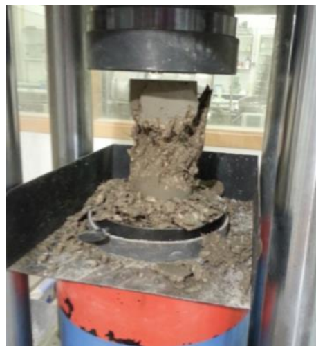
Ilustración 50: Probetas ensayada a 9 horas , la falla ocurre a menos de 1 MPa.
