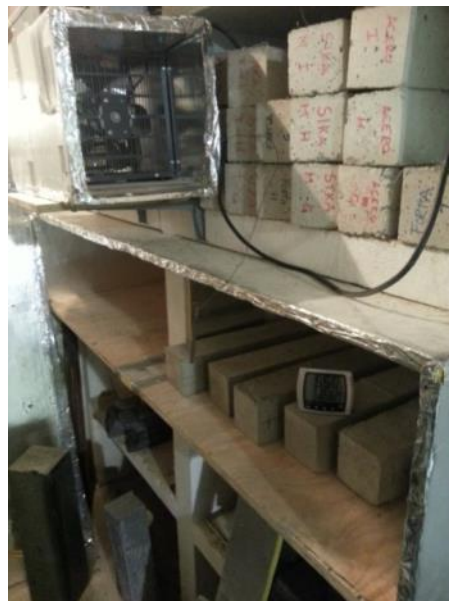
Ilustración 41: Cámara de retracción. Ventilador industrial conectado a un termostato.
