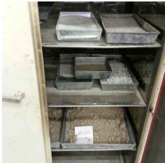
Ilustración 45: Horno de laboratorio a temperatura de 110 C. Se utilizó para secar los áridos y sacar las humedades.
