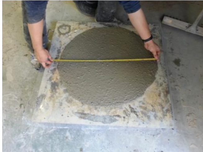
Ilustración 30: Escurrimiento de hormigón autocompactante
