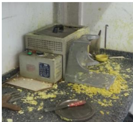
Ilustración 38: Calentador de azufre y nivelador de refrenado para probetas de \varnothing = 150 mm.
