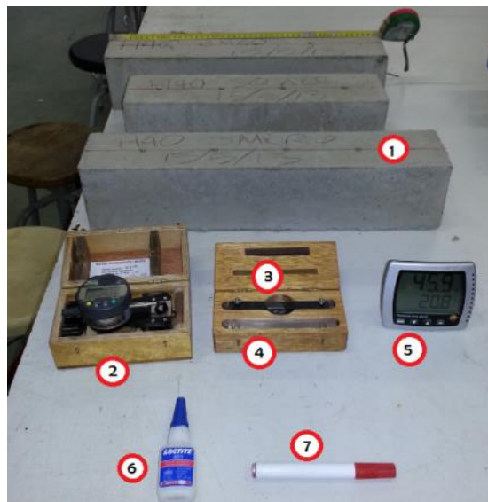
Ilustración 34: 1) Probeta con puntos de MEK. 2) DEMEK. 3) espaciador macho. 4) calibrador hembra. 5) hidrómetro. 6) pegamento. 7) rotulador.
