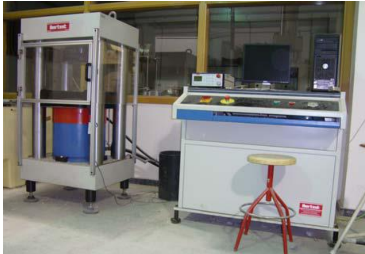
Ilustración 39: Prensa servocontrolada Ibertest, modelo MEH-3000-LCMD2W de 3000 kN.
