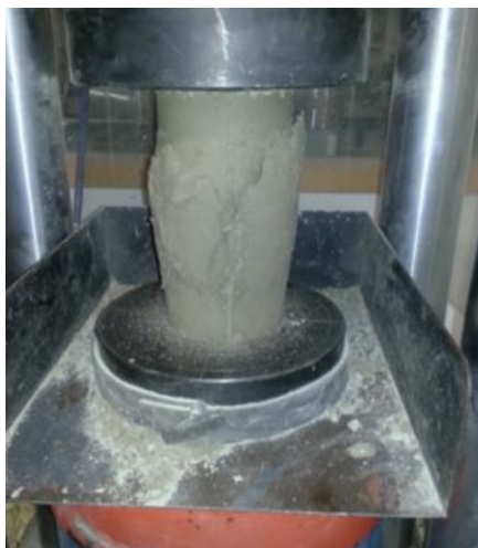
Ilustración 50: Probetas ensayada a 9 horas , la falla ocurre a menos de 1 MPa.
