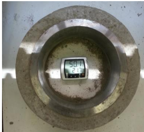
Ilustración 35: Especimen de anillo de hormigón restringido internamente con anillo de acero. Hidrómetro (medidor de temperatura y humedad el aire) en el interior del anillo.
