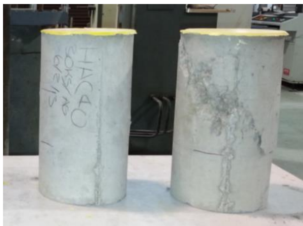
Ilustración 51:Foto 5.1.2 d Probetas ensayada a 11 horas después de la falla a 3.5 MPa. Se aprecia la probeta más seca y el tipo de falla vertical de arriba hacia abajo.
