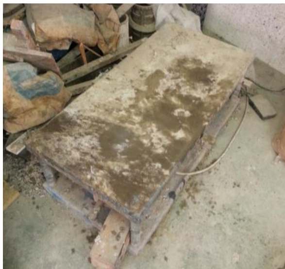
Ilustración 43: Mesa de vibración, se utilizó para compactar y sacar el oxígeno atrapado en las probetas de hormigón tradicional.
