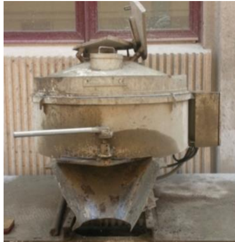
Ilustración 37: Hormigonera Marca Betonmass, modelo ST 150 CD, de eje vertical y tambor fijo, capacidad máxima de 100 litros. Este equipo se utilizó para todas las amasadas.
