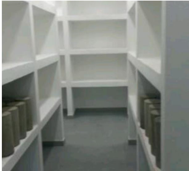
Ilustración 44: Cámara húmeda de curado, 100%HR. 20 C.
