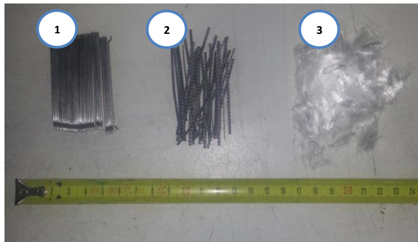
Ilustración 21: Fibras de refuerzo utilizadas para los ensayos: 1) Metálica 2) Sintética macro 3) Sintética micro
