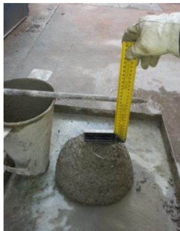
Ilustración 29: Prueba de asiento con cono de Abram's
