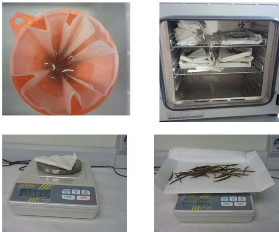
Figura 3: Fotos del proceso de pesado de las partículas contaminantes: polvo retenido en el filtro, interior de la estufa, pesado del filtro después de secado en la estufa y pesado de las hojas secas después de secadas en la estufa.
