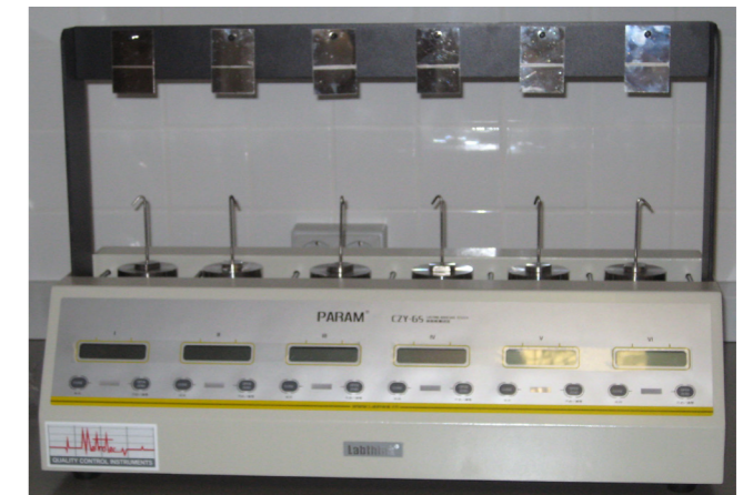
Fig. 55: Imagen medidor ensayos de cohesión.
