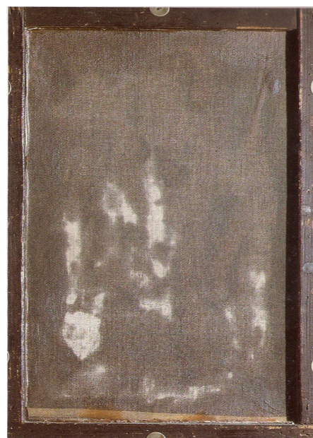
Fig. 12: Impregnación a base de cera-resina.
