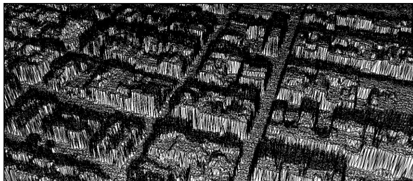
Figura 2. Datos LiDAR dispuestos en triangulación de Delaunay.
